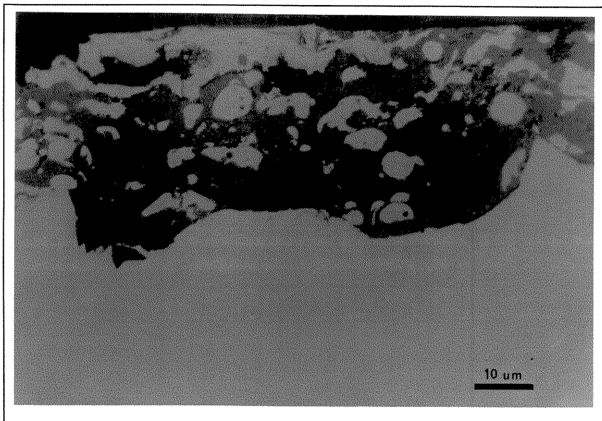
FIGURA 52 - Seção transversal do CP 04 - Interface substrato / camada de base 50-50.
