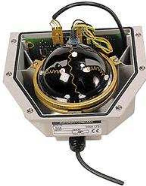
Figura A.5: Bússola de fluxo de porta em suspensão fluídica.
