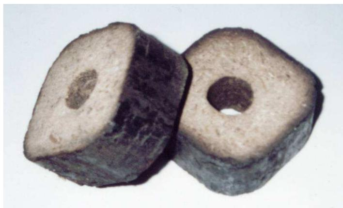
**Figura 4.7. Pedacos de briquetes de seção quadrada**
