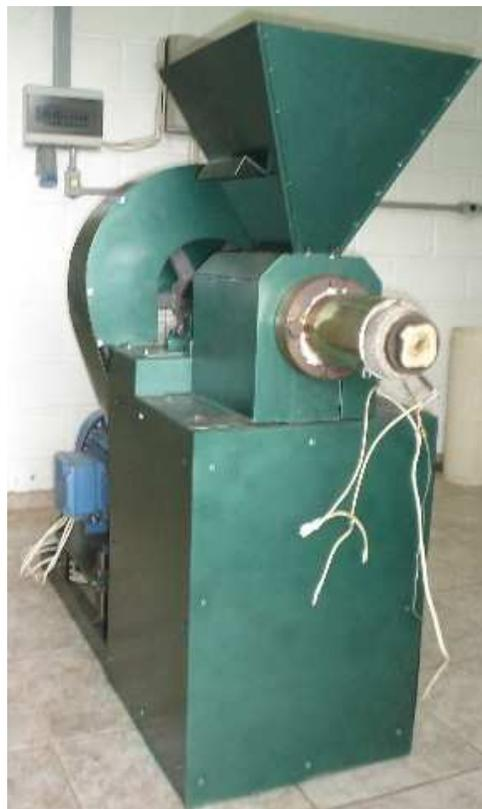
**Figura 4.4. Briquetadeira BIOTOR-R100 com acabamento final**
