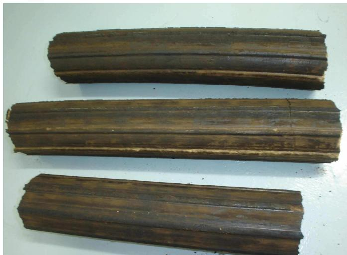
**Figura 4.5. Briquetes de seção redonda**
