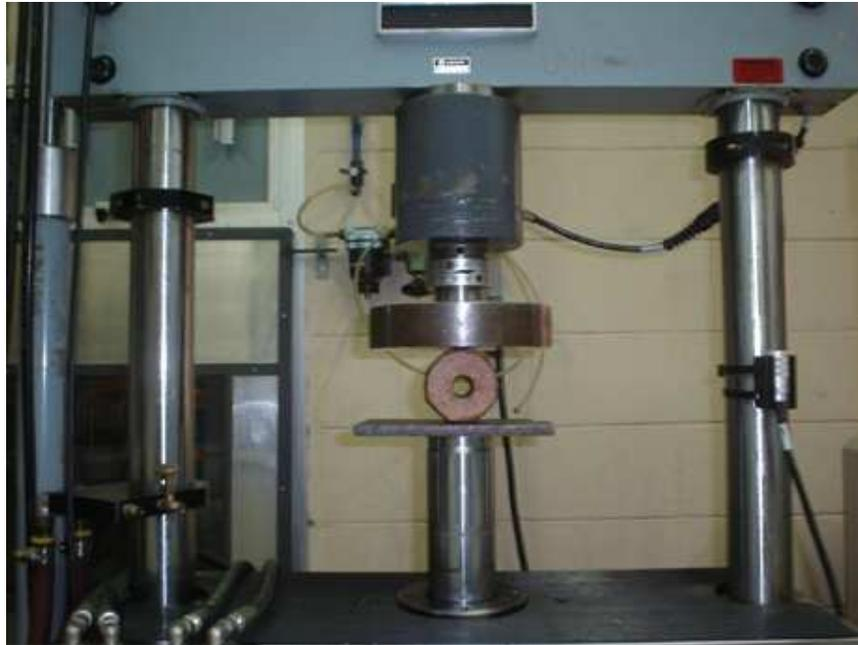
**Figura 4.14. Prensa preparada para teste de resistência radial**
