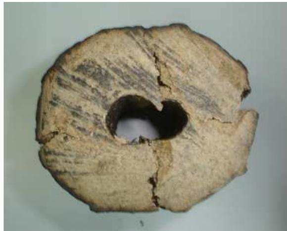
**Figura 4.15.** Amostra de briquete de casca de arroz quebrada após o ensaio mecânico
