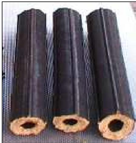
**Figura 2.4. Briquetes de prensa de parafuso com matriz de seção circular.**
