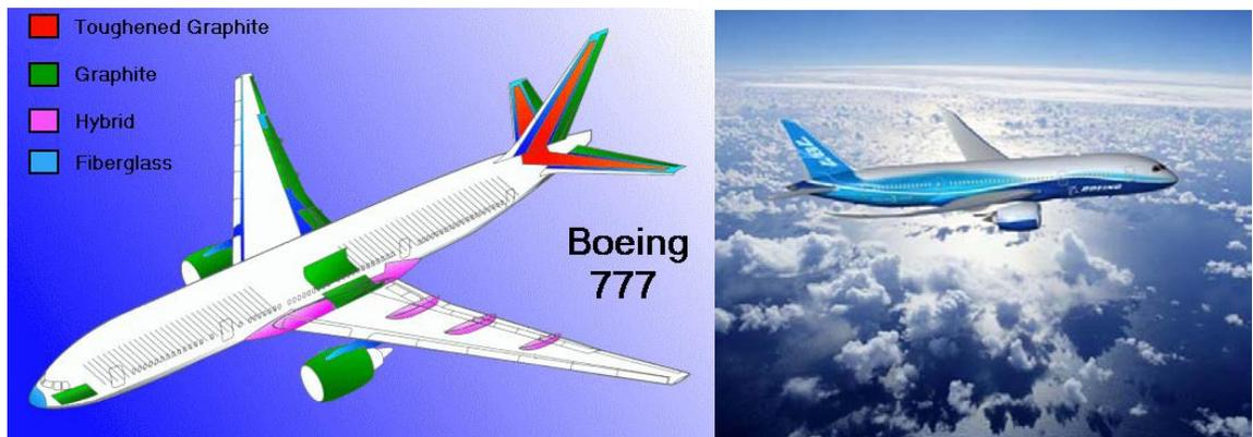
Figura 2.4: Aplicações de compósitos no B777 e B787.
