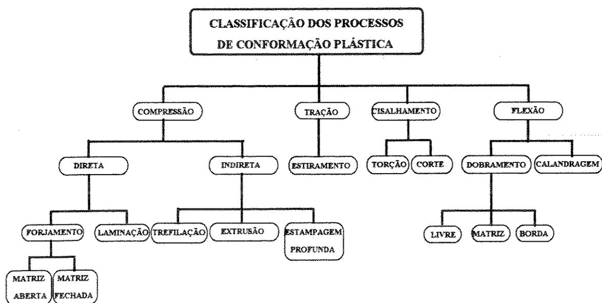
Figura 2.1 - Classificação geral dos processos de conformação convencionais.
