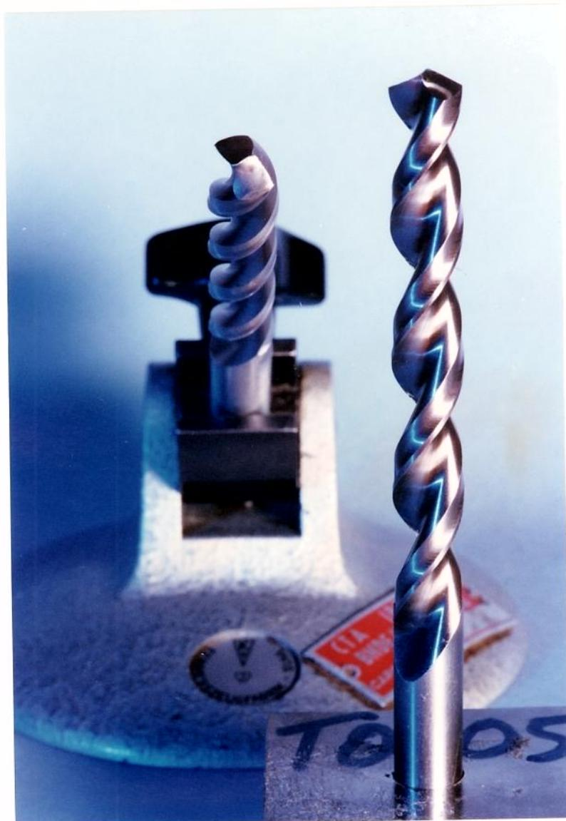
Figura 3.14 - Perfil N° 13, com a afiação tipo "Helical".
