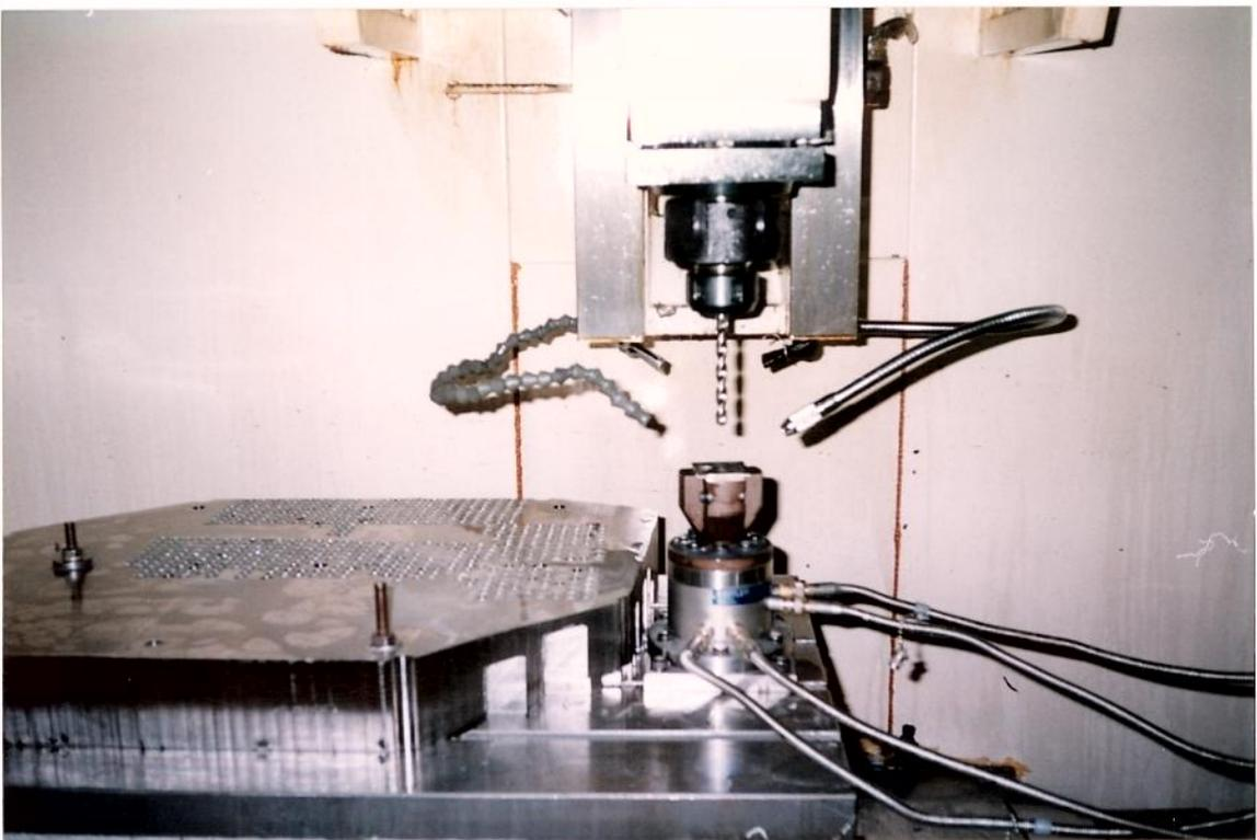
Figura 3.5b - Vista parcial do dinamômetro utilizado nos ensaios.
