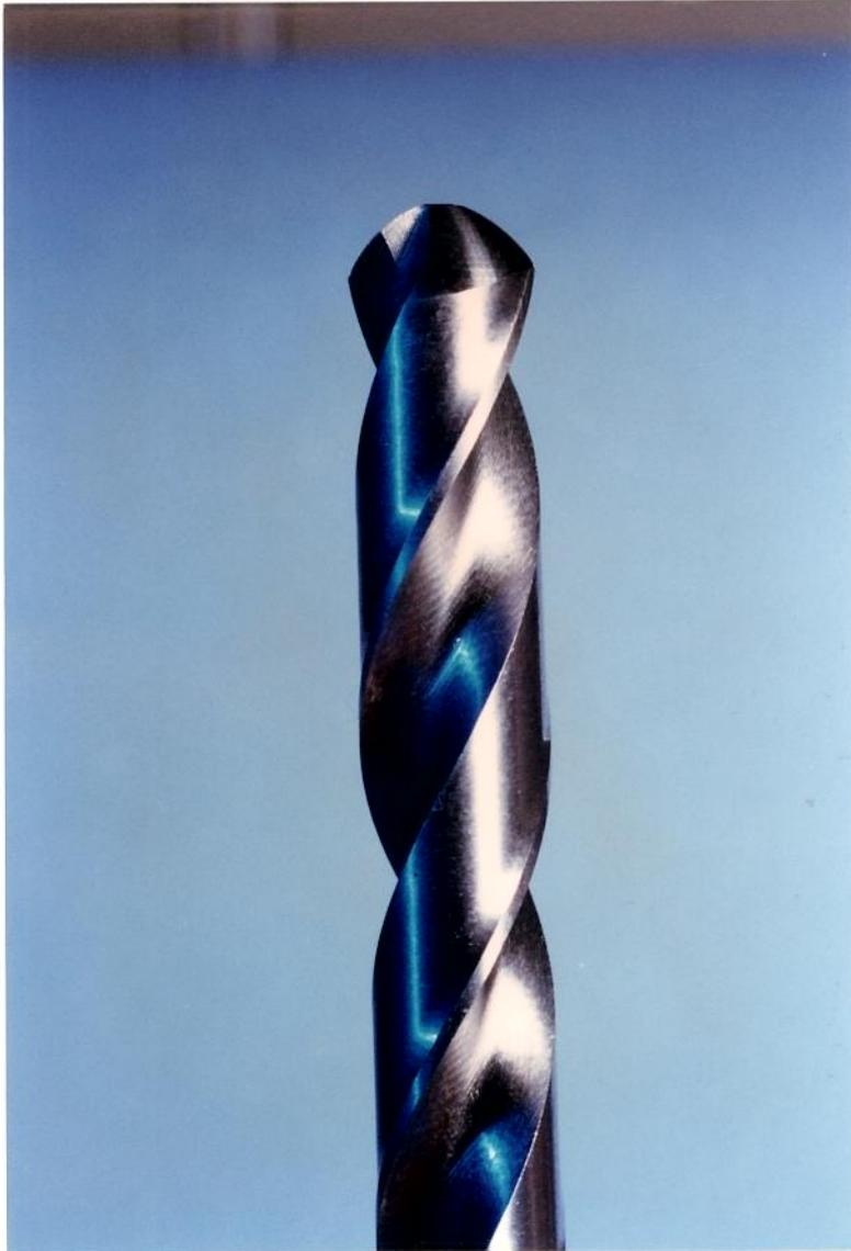
Figura 3.7 - Ferramenta com a afiação tipo "Racon".
