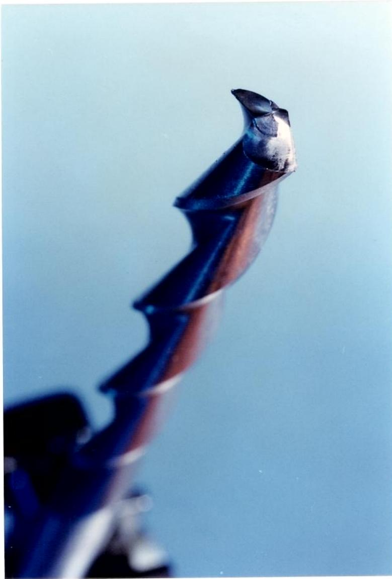
Figura 4.53 - Cavaco formado pela aresta transversal para o perfil número 9.
