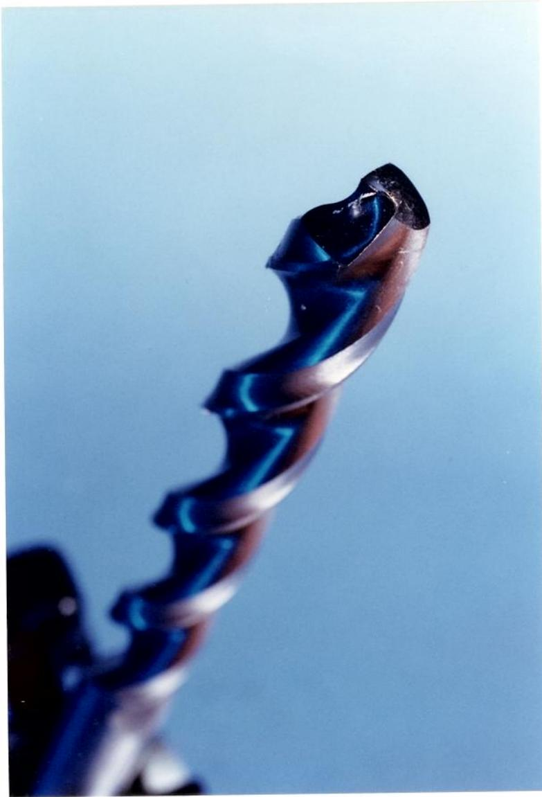
Figura 4.54 - Cavaco formado pela aresta transversal para o perfil número 13.
