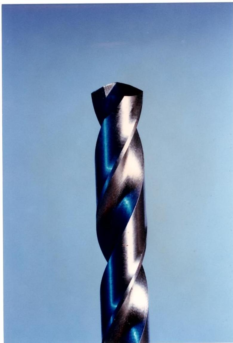
Figura 3.9 - Ferramenta com a afiação tipo cruzada NAS P3 [NAS 907,1986].
