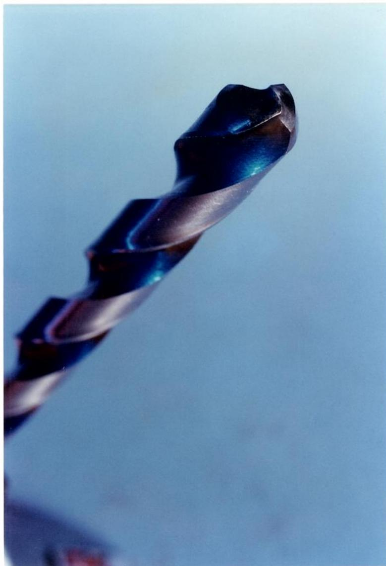
Figura 3.8 - Ferramenta com a afiação tipo “Bickford”.
