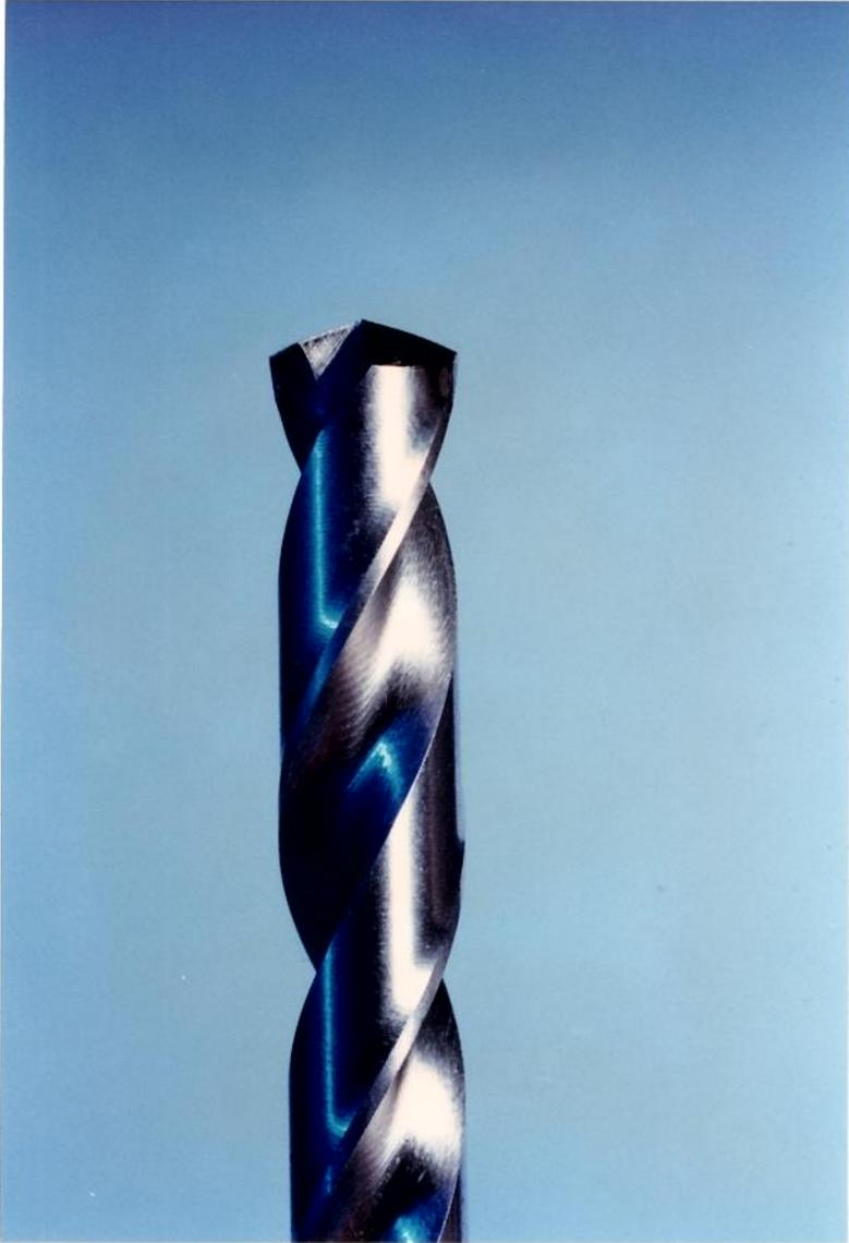
Figura 3.10 - Ferramenta com a afiação tipo cruzada P9 [NAS 907,1986].
