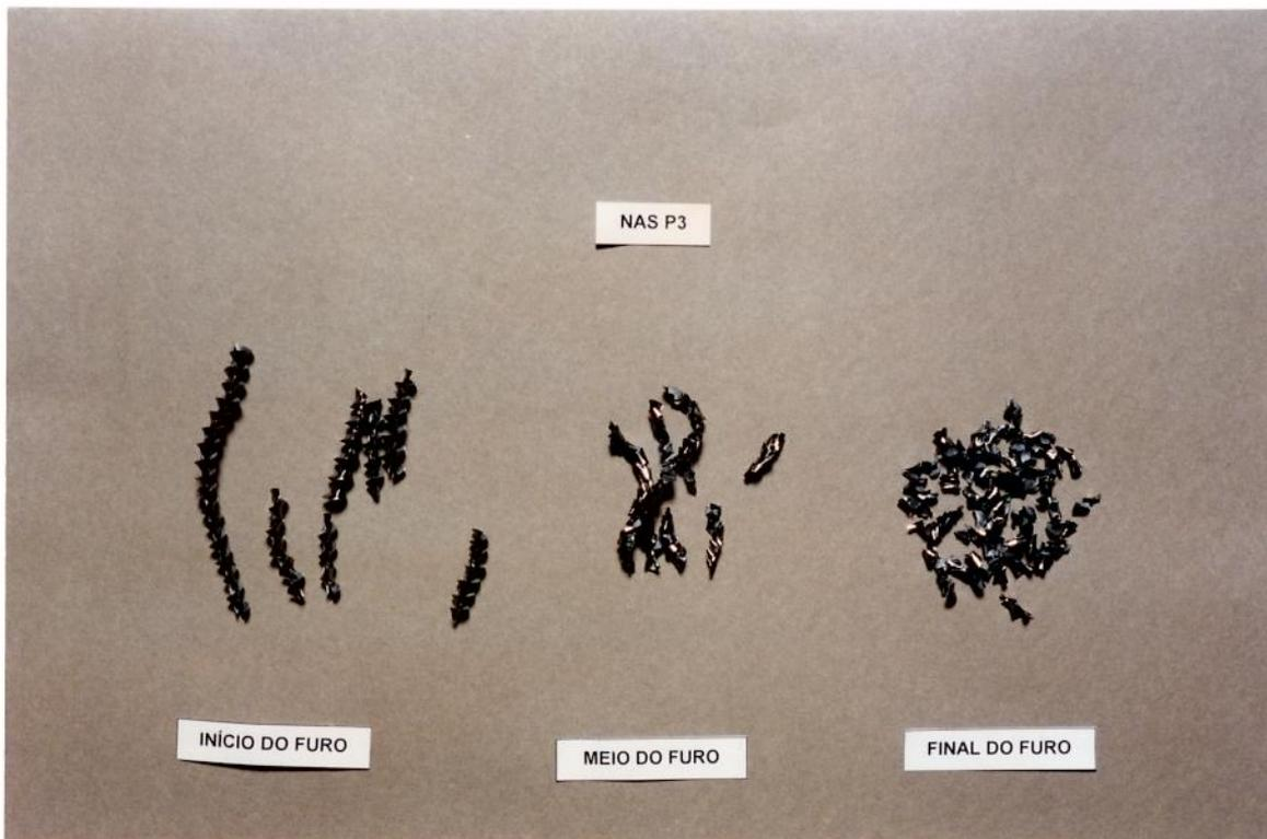
Figura 4.12 - Variação da forma do cavaco para afiação do tipo NAS P3.
