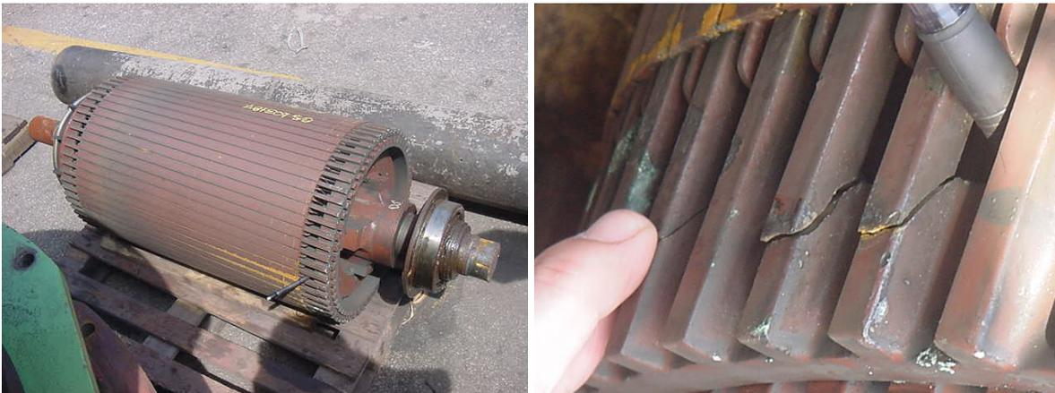
Figura 4. 11 - Exemplo de rotor com barras quebradas.
