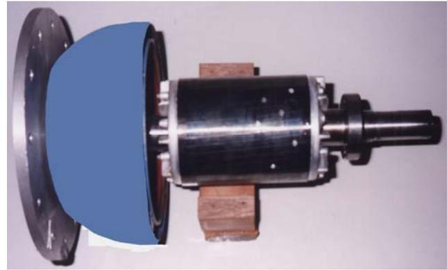
(b) Rotor com as sete barras rompidas.
