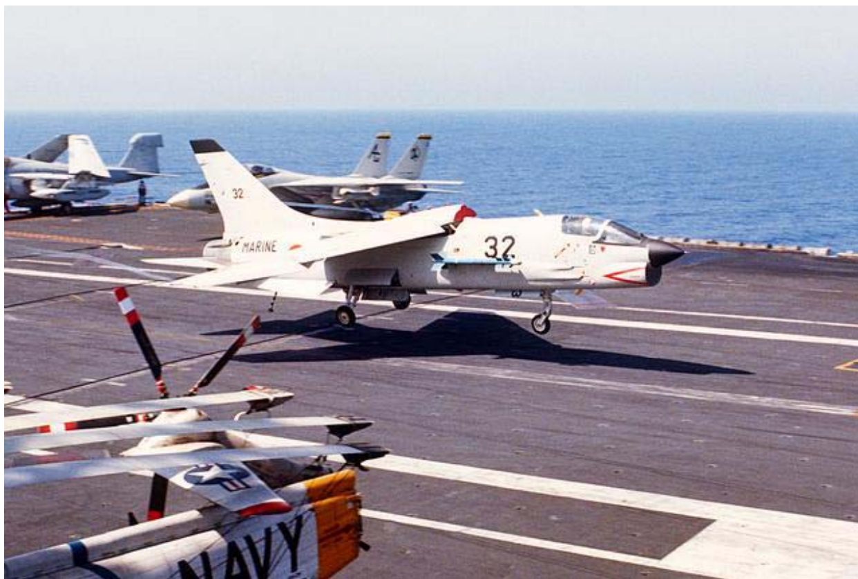
Figura C-4: Landing do F-8 Crusader em um Porta-Aviões e a característica do ângulo de ataque variável
