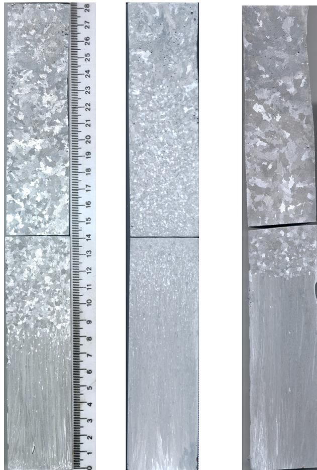
Figura 2.3 Macrografia da liga AA5052 vazadas pelo processo de solidificação unidirecional, para diferentes graus de superaquecimento [Sousa, 2006].
