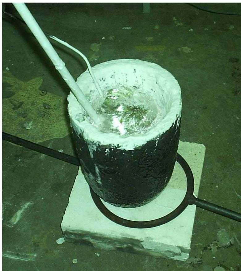
Figura 3.7—Injeção de gás argônio no metal líquido e controle de temperatura; lança de gás e medidor de temperatura.
