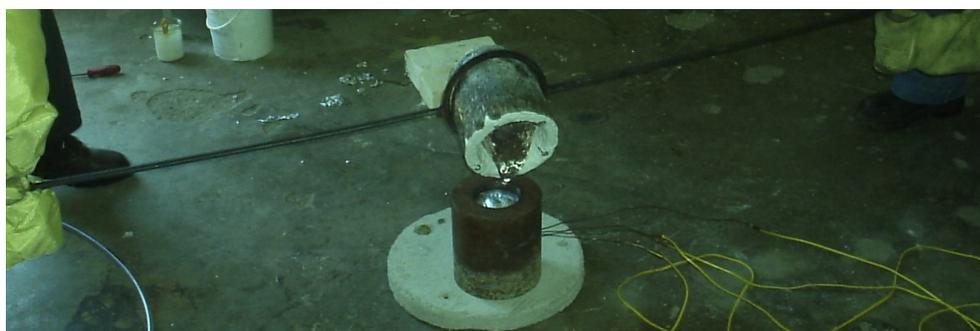
Figura 3.6 - Dispositivo utilizado durante experimento; Molde de aço radial cilíndrico, cadinho e termopares.
