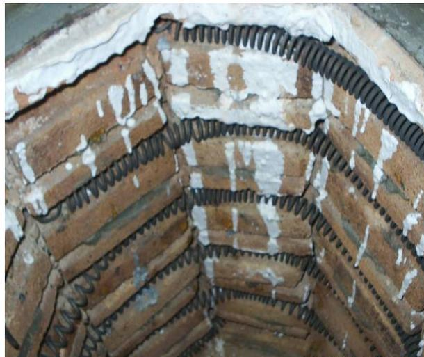
Figura 3.2—Detalhe interno do forno mostrando a resistência elétrica.
