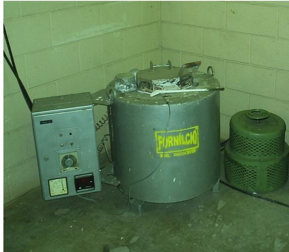
Figura 3.1—Forno de resistência elétrica utilizado para fundir a liga.
