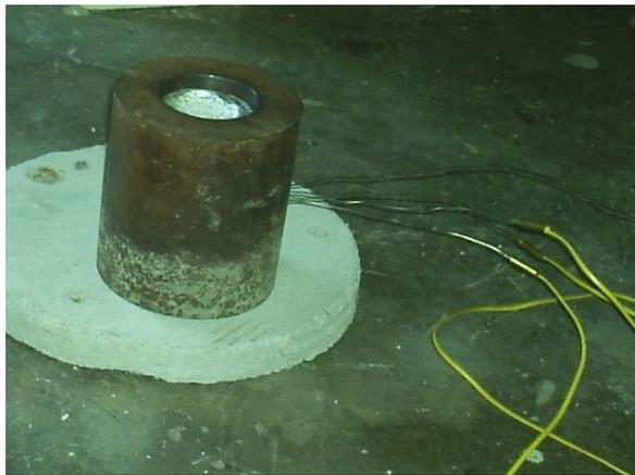
Figura 3.4—Dispositivo radial cilíndrico acoplado a termopares e sistema de aquisição de dados.
