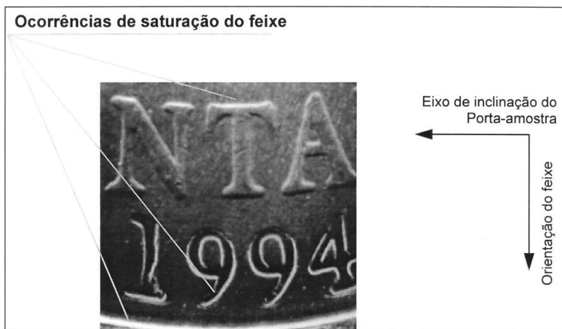
**Figura 4.6** Saturação do feixe eletrônico em amostras com variação de relevo. (MEV, elétrons secundários, 22X, 20 kV, distância de trabalho de 11 mm, inclinação de  $30^\circ$ )
