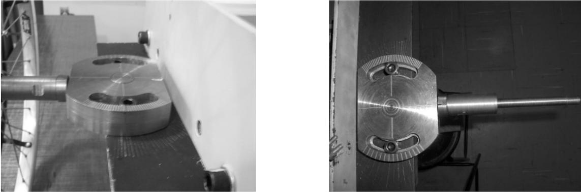
Figura 8.6 Sistema para alteração do ângulo da roda, ângulo de escorregamento ( $\alpha$ ).
