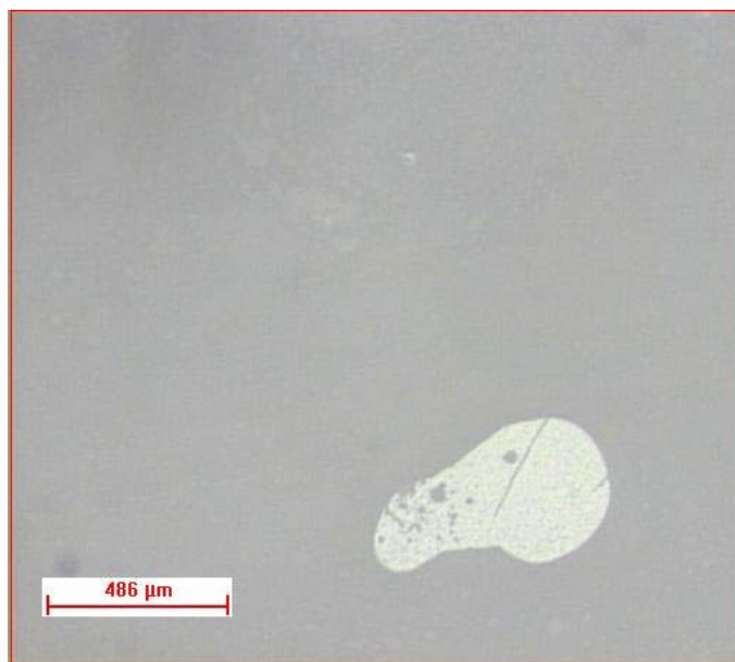
Figura 4.9 Fotografia de uma bolha de ar emulsionada no óleo
