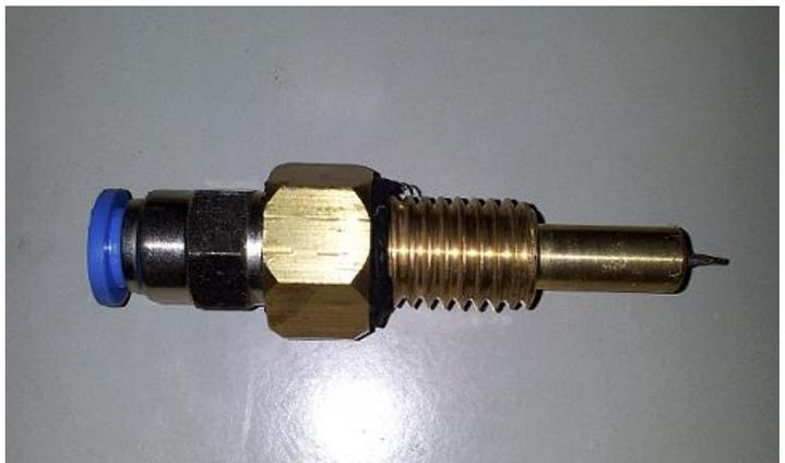
**Figura 4-9 - Bicos de injeção de ar utilizados.**
