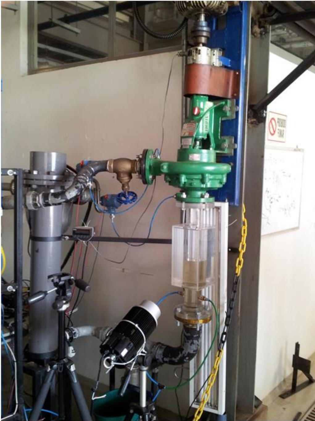
**Figura AA - 2 – Vista lateral mostrando o aquecedor elétrico à esquerda, o aquário em acrílico e a bomba teste**
