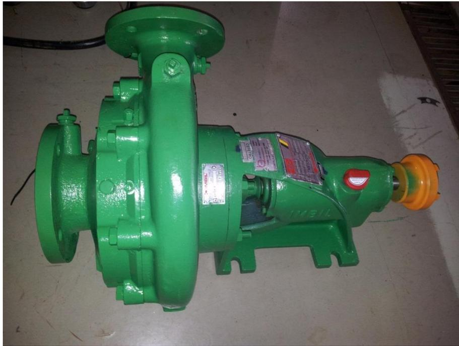
**Figura 4-2 – Foto da bomba teste Imbil ITA 65 330/2**
