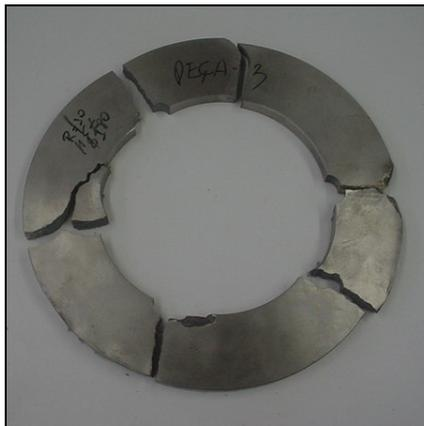
**Figura 4.21** – Corpo de prova “C2”, raio interno = 10mm – Após teste.
