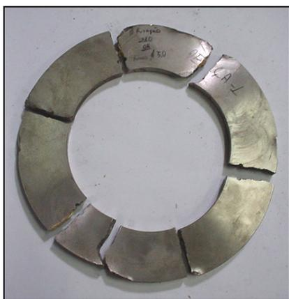
**Figura 4.27** – Corpo de prova “D2”, diâmetro do furo = 5mm – Após teste.
