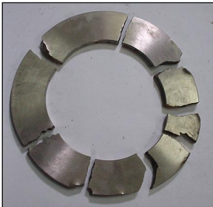
**Figura 4.15** – Corpo de prova “B2”, raio externo = 10mm – Após teste.
