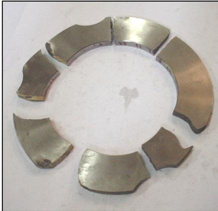
**Figura 4.39** – Corpo de prova “F2”, raio externo = 45mm – Após teste.
