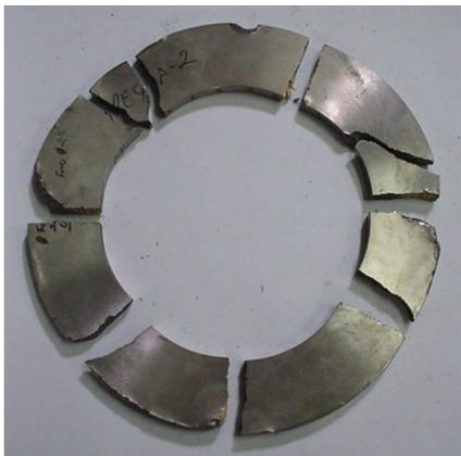
**Figura 4.25** – Corpo de prova “D1”, diâmetro do furo = 2,5mm – Após teste.
