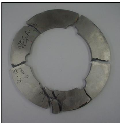
**Figura 4.23** – Corpo de prova “C3”, raio interno = 15mm – Após teste.
