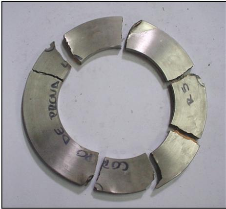
**Figura 4.13** – Corpo de prova “B1”, raio externo = 5mm – Após teste.
