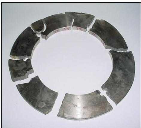
**Figura 4.29** – Corpo de prova “D3”, diâmetro do furo = 10mm – Após teste.
