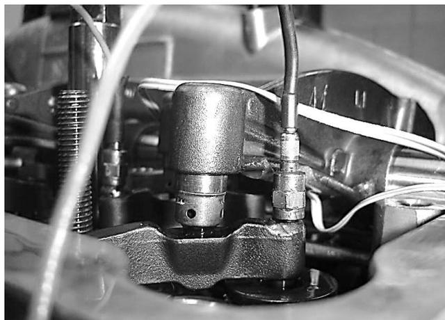
Figura 6-2 – Ponte de válvulas com acelerômetro montado no motor<sup>11</sup>
