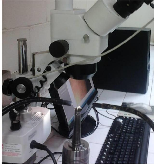
Figura 3.2 – Montagem utilizada para medição do desgaste das ferramentas.
