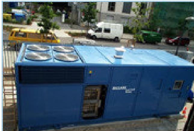
Figura 2.7 – Unidade PEMFC de 250 kW desenvolvido pela Ballard Power Systems
