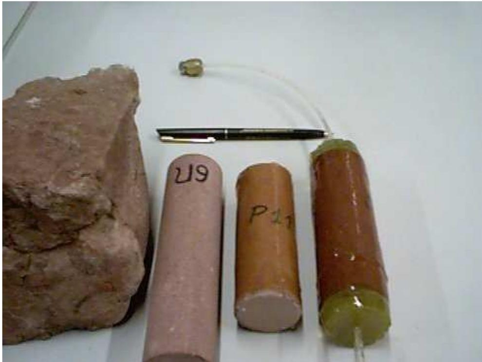
Fig. 4.2 – Amostras de rocha sedimentar (arenito Botucatu). A partir da esq.: bloco bruto; amostra usinada na forma cilíndrica; amostra com camada preliminar de resina; amostra encapsulada, com cabeçotes de acrílico e com tubos de entrada e saída de fluidos.
