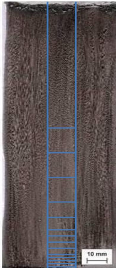
**Figura 3.12** – Representação esquemática da posição de retirada das amostras para análise da macrossegregação (amostra obtida no presente trabalho).
