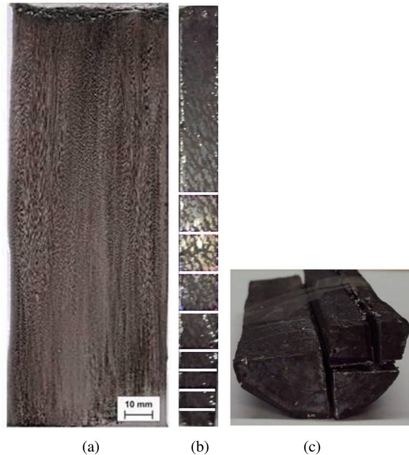
**Figura 3.9** - (a) Macroestrutura de liga Pb-Bi; (b) Preparação das amostras para a análise da microestrutura; (c) Lingote após cortes longitudinais (amostras obtidas no presente trabalho).
