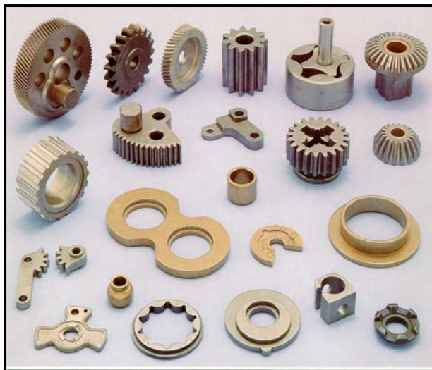
FIGURA 1.1- Conjunto de peças típicas obtidas através da metalurgia do pó. Trata-se de buchas, pinos, juntas metálicas, bielas de compressores e de motores a combustão interna e uma infinidade de outras, que exigem um determinado padrão de qualidade, e que em inúmeras vezes, poderiam ser fabricadas a partir da compactação e posterior sinterização de certas misturas de cavaco proveniente dos processos de usinagem com metais em pó [23].
