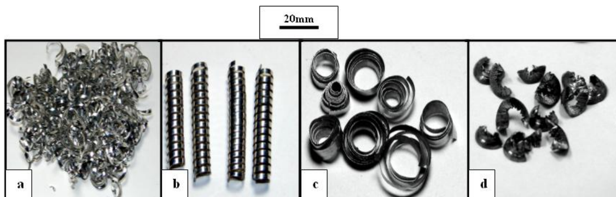
FIGURA 3.1- Diferentes formas que os cavacos assumem quando são gerados durante operações de torneamento. (a) fita, (b) helicoidal, (c) espiral e (d) em lascas.
