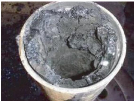
Figura 1.2: Deposição de asfalteno em tubulação [Mullins 2008].
