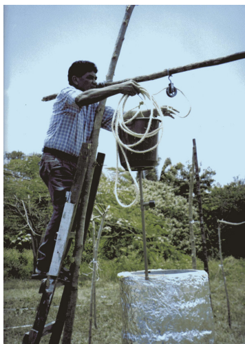
FIGURA 3.9 – Colocação do sistema balde dependurado pela polia fixa
