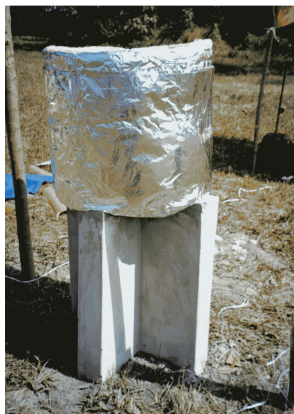
FIGURA 3.3 – Piscina solar sobre a sapata de alvenaria
