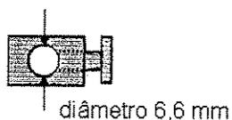
FIGURA 3.5 - Terminal de Fixação de Varetas de Alumínio .
