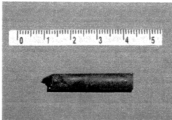
Figura 3.4. Lingote produzido no forno de solidificação direcional.
