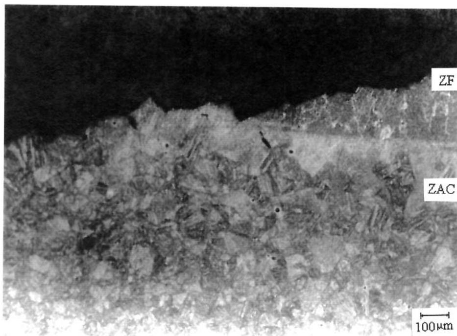
FIGURA 5.27 - Região transversal da superfície fraturada.
