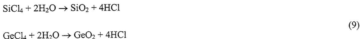
Ao final do processo de deposição, retira-se o bastão inicial e obtém-se uma preforma porosa (denominada de “preforma-soot”) com um furo central, a qual é colocada em um forno próprio para serem feitos os processos de desidratação e consolidação da preforma, transformando o “soot” poroso em vidro totalmente transparente.
