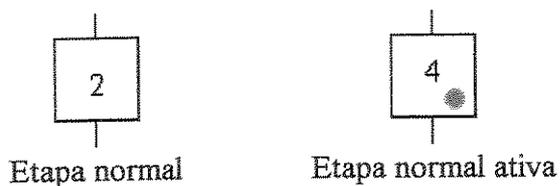
Figura a8.3 - Representação esquemática das etapas normais de um Grafcet
