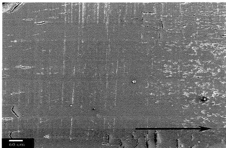
Figura 4.42 - Micrografias da superfície de desgaste de p(HEMA-co-NVP) (10% p/p) 5% AR ( $v=0,50 \text{ ms}^{-1}$  e  $p=5,5 \text{ MPa}$ ).
