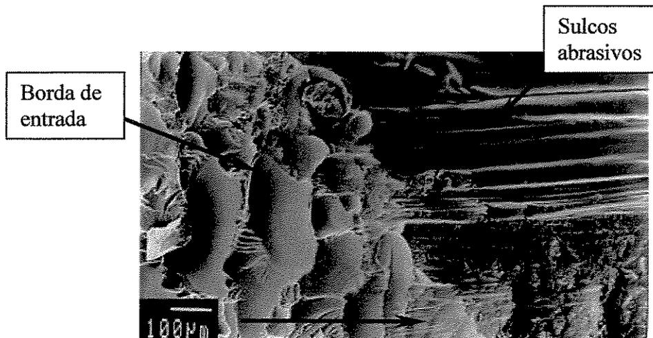
Figura 4.31 - Micrografias da superfície de desgaste de p(HEMA-co-NVP) (10% p/p) 5% AR ( $v=0,33 \text{ ms}^{-1}$  e  $p=4,0 \text{ MPa}$ ).
