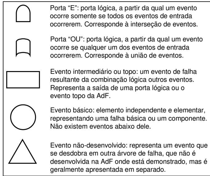
Figura 3.4: Alguns símbolos utilizados em análises por Árvore de Falhas
