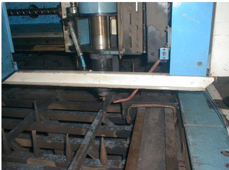
**Figura 3.15** – Sistema de injeção de gás fixado junto ao cabeçote.
