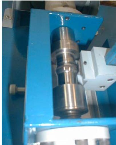
**Figura 3.20** – Corpo de prova sendo pressionado contra a esfera em rotação formando a calota de desgaste.
