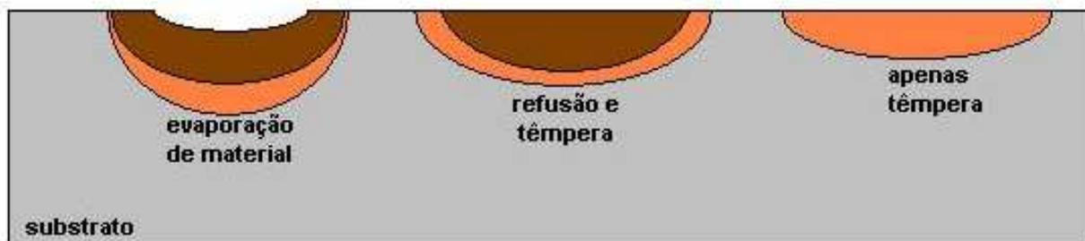
**Figura 3.12** – As três possíveis situações após o feixe de laser
