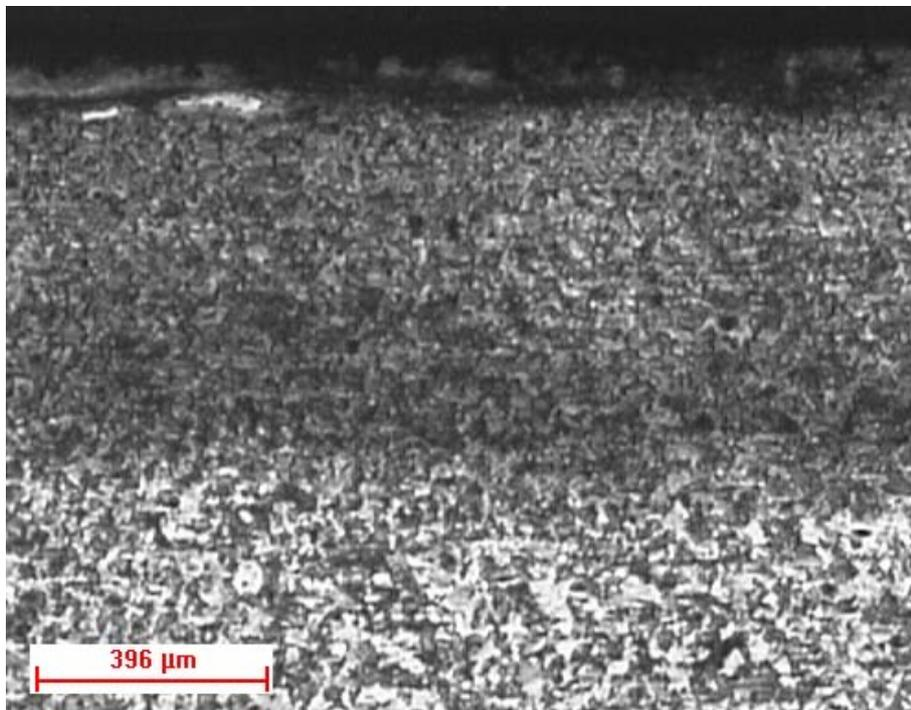
**Figura 4.36** – Sobreposição de trilha do aço AISI 1045 pré-nitretado e tratado a laser com  $v = 8.10^3$  mm/min. Ataque com nital 3%.
