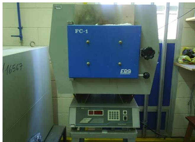
**Figura 3.4** – Forno tipo mufla utilizado nos tratamentos térmicos das amostras.
