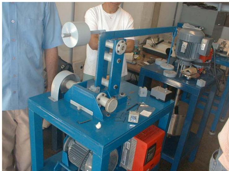
**Figura 3.19** – Máquina de desgaste microabrasivo.
