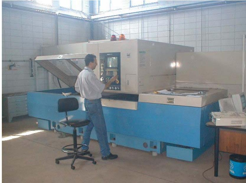
**Figura 1.1** – Equipamento de Laser tipo CO<sub>2</sub> pertencente ao LNLS usado nos experimentos e operado através de comando computacional.
