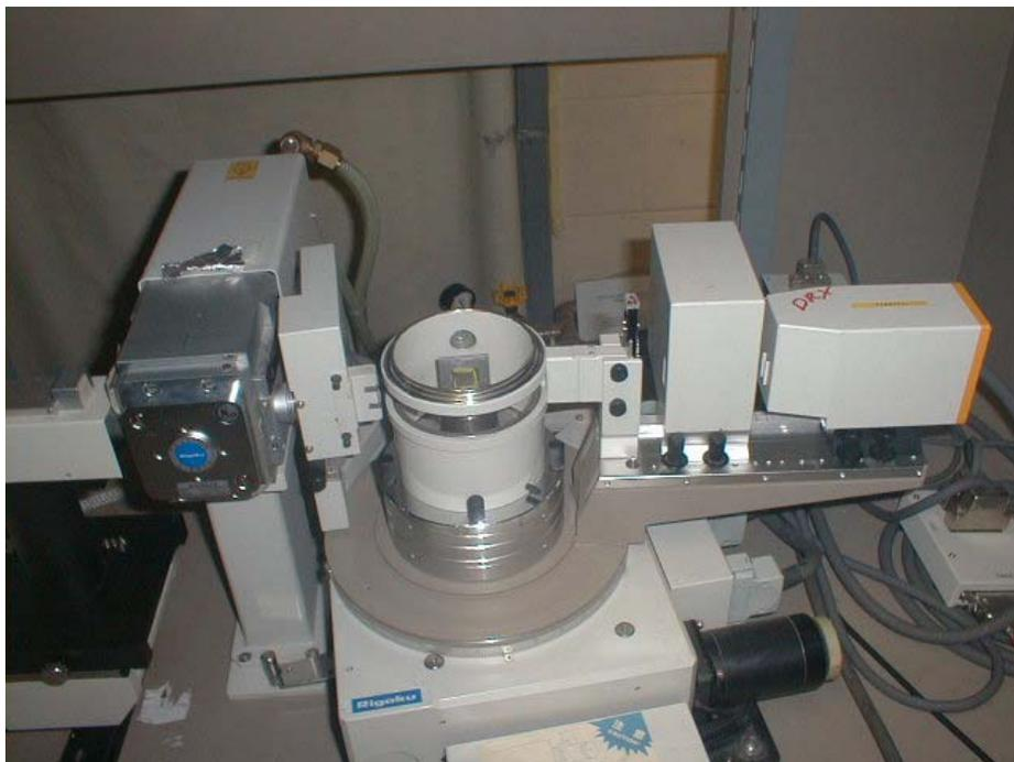
**Figura 3.17** – Difratorômetro de Raios X.
