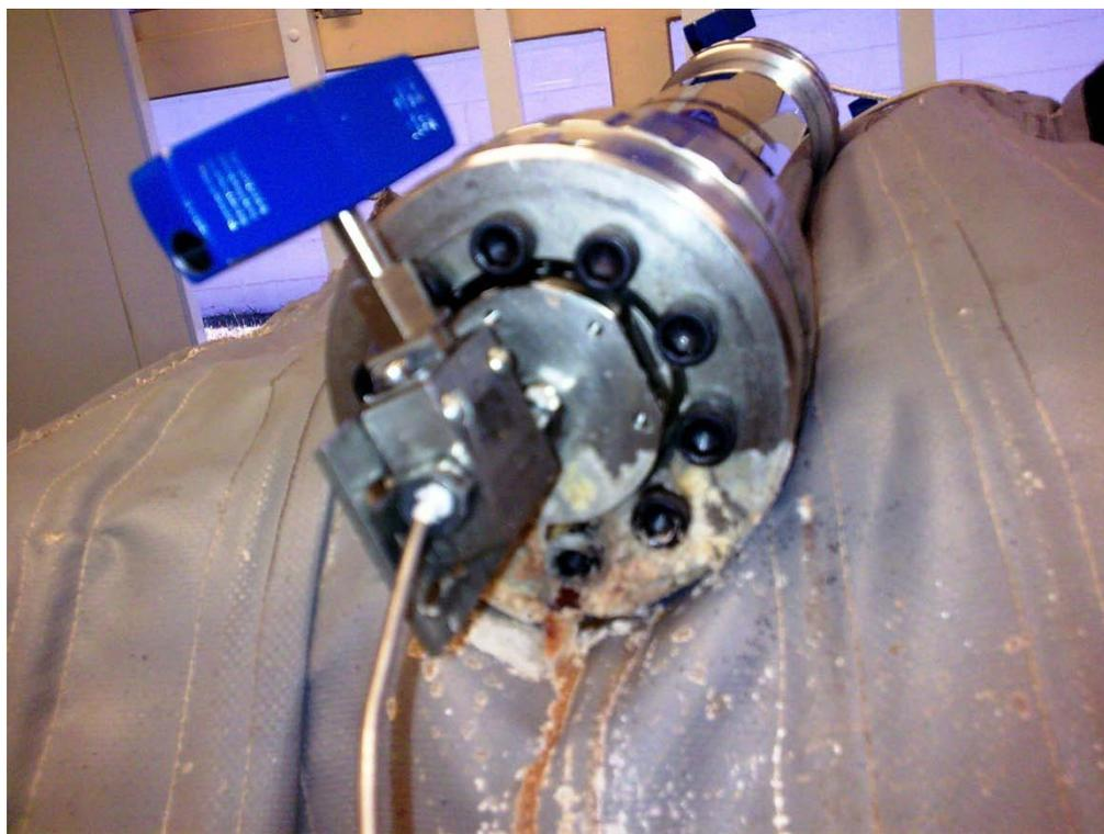
**Figura 4-6: Foto de vazamento na garrafa da salmoura carbonatada.**
