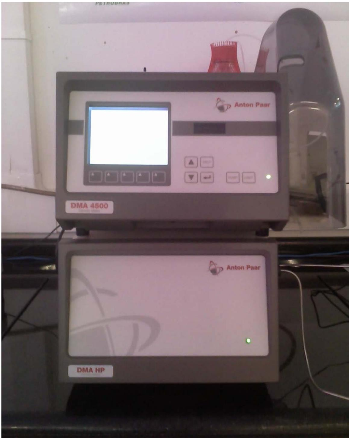
**Figura 3-9: Densímetro com célula externa de alta pressão.**
