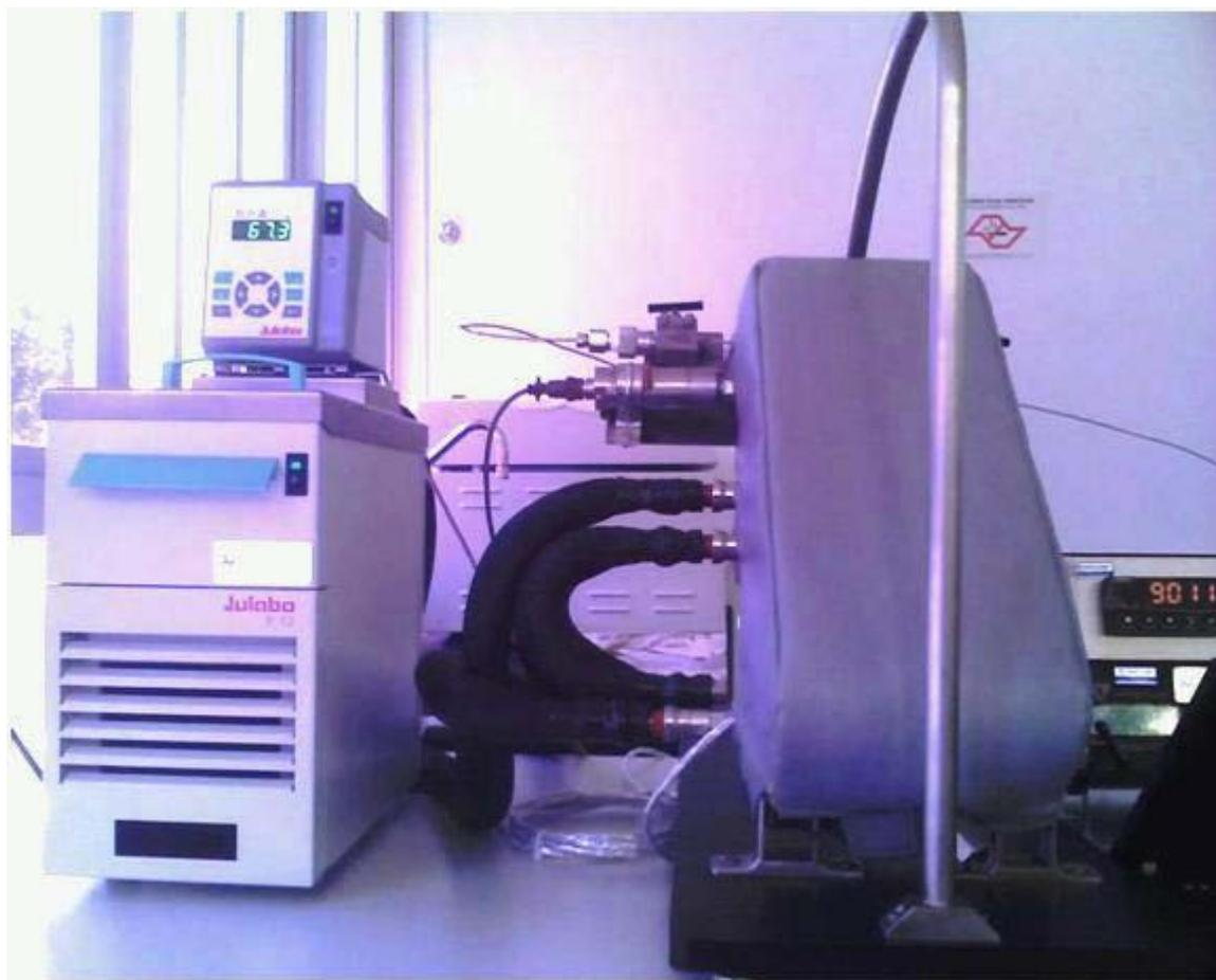
**Figura 3-8: Viscosímetro de alta pressão.**
