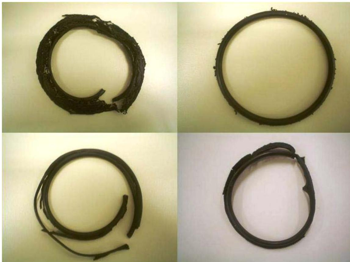
**Figura 4-4: Foto dos o’rings danificados.**
