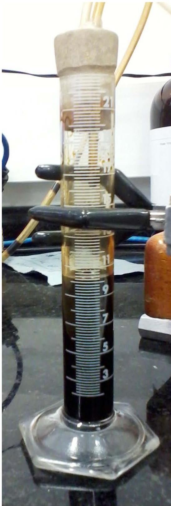
Figura 3-10: Coleta da amostra de óleo no teste *flash*.
