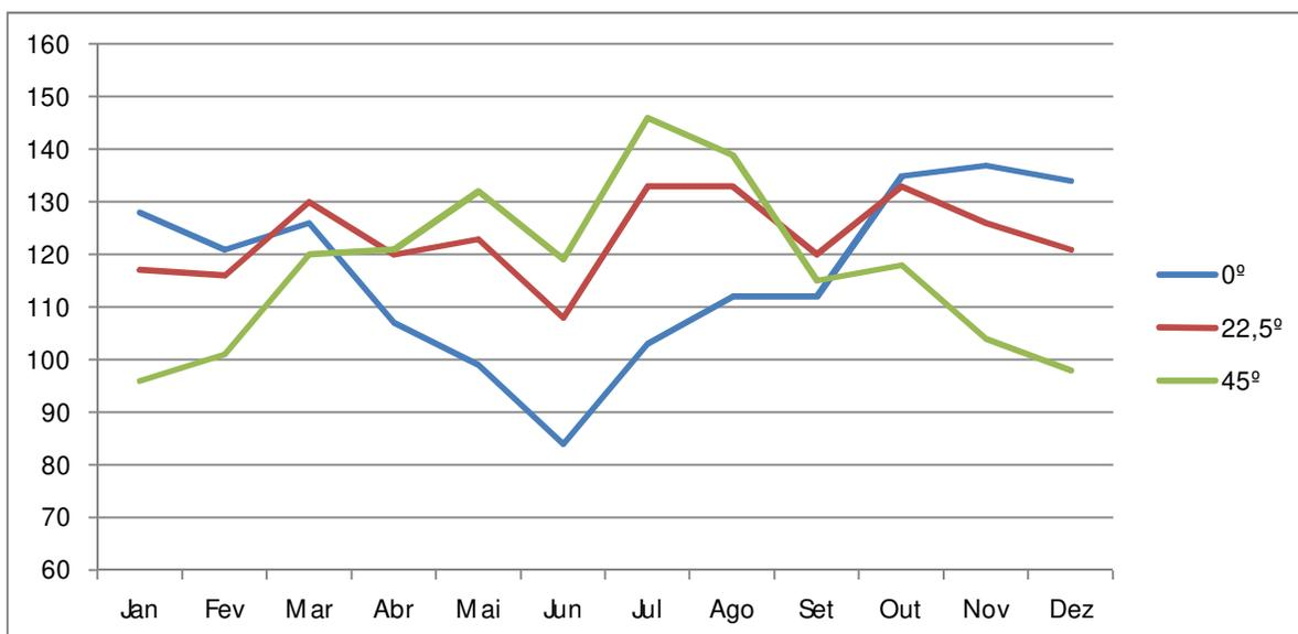
**Gráfico 12 – Perfil da Geração mensal de eletricidade de sistemas fotovoltaicos com inclinações de 0°, 22,5° e 45°, em kWh**
