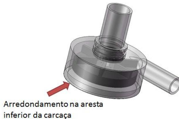
**Figura 5.4** – Imagem da BSAV apontando a aresta onde foi adotado um arredondamento.
