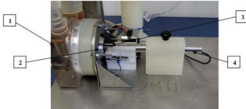
**Figura B3** Montagem do LVDT em conjunto com o propulsor. [1] Câmara de bombeamento; [2] Motor *Brushless DC*; [3] Cursor acoplado à membrana flexível; [4] LVDT.
