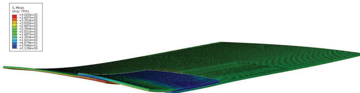
Figura 8.28: Distribuição da tensão de von Mises no subcomponente para uma tensão remota de 225 Mpa.
