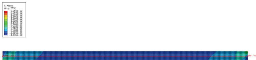
Figura 8.22: Distribuição de tensão de Von Mises no adesivo.
