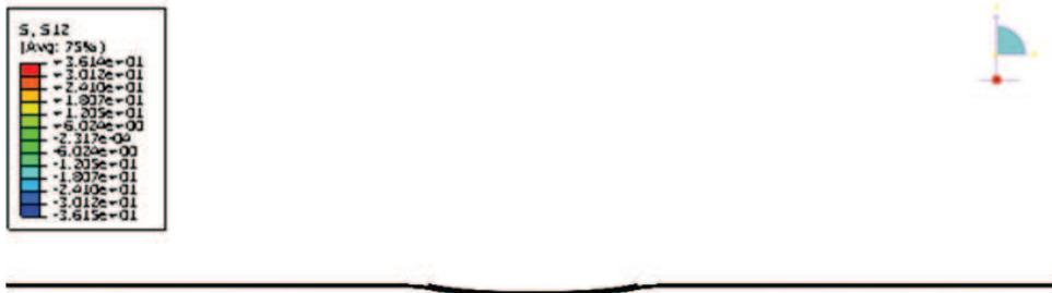
Figura 4.12: Deformação do *doubler* na escala de 5:1 de ampliação com a aplicação da carga.
