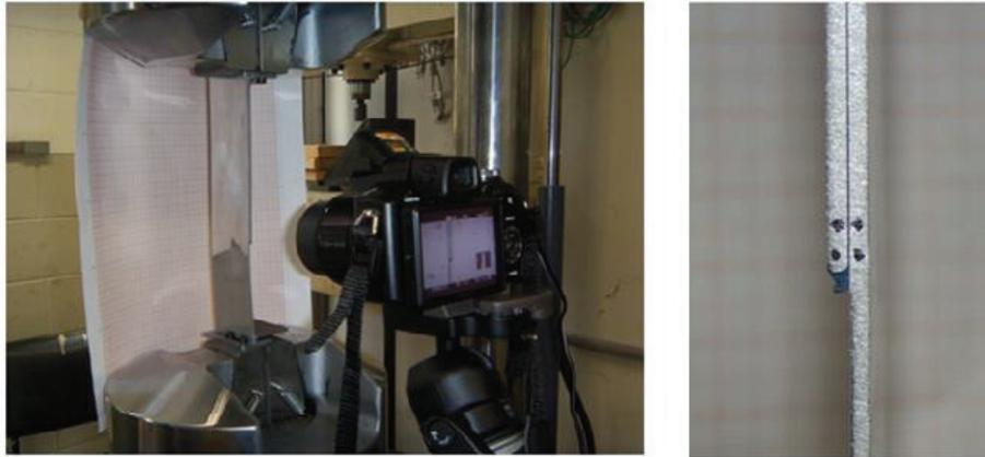
Figura 7.25: Aquisição de dados para o PDI
