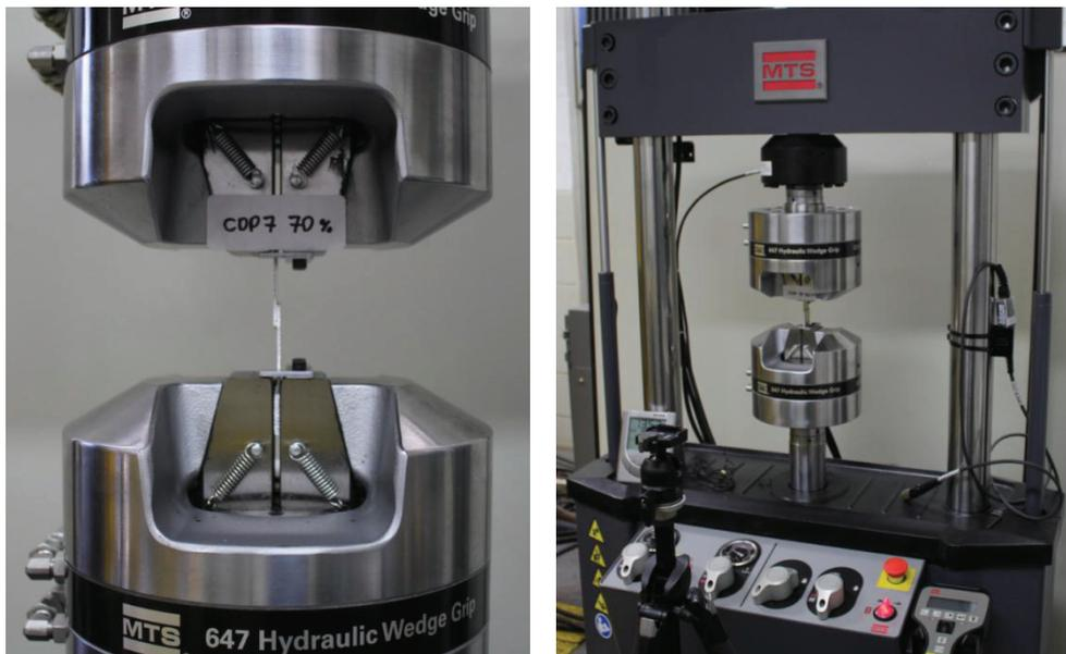
Figura 8.15: Montagem dos CDPs na MTS.
