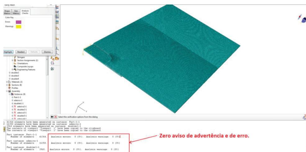
Figura 4.4: Controle da malha do subcomponente.
