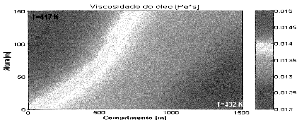
Figura 6.11: Mapa da viscosidade do reservatório devido ao perfil térmico, a variação total foi 20% do extremo mais frio ao mais quente.
