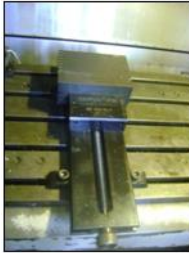
Figura 3.1 – Fixação da peça por morsa
