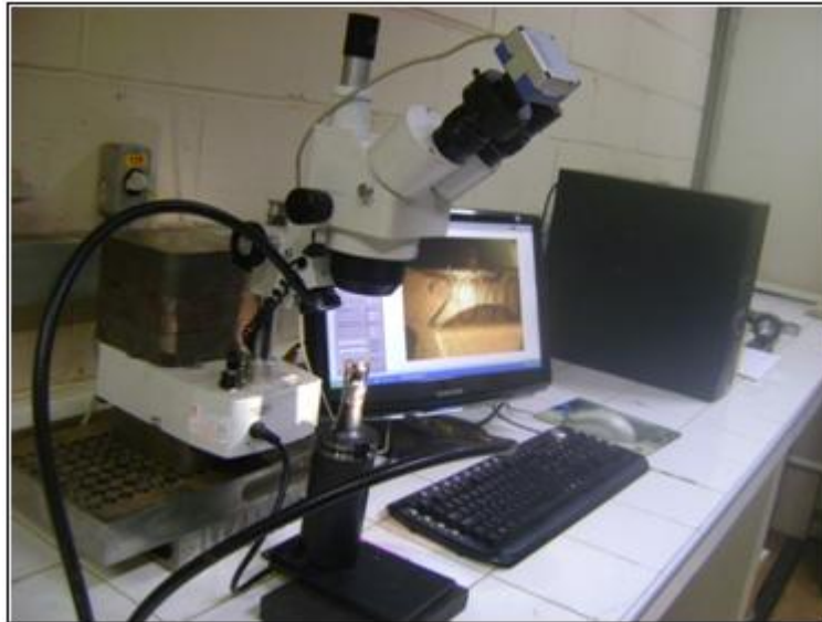
Figura 3.5 – Medição do desgaste em um microscópio estereoscópio.
