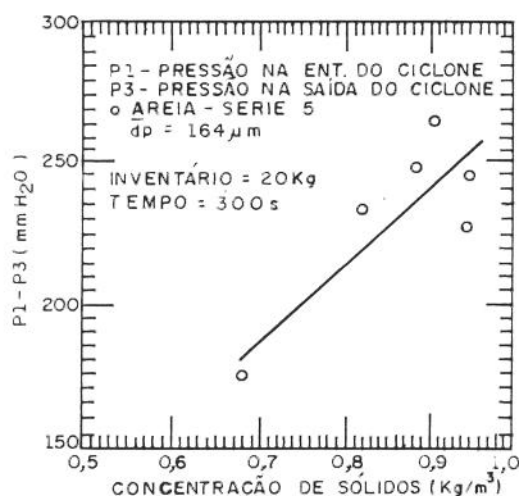
Fig. 2.16 - Efeito da concentração de sólidos na diferença de pressão entre a entrada e a base do ciclone.- Testes com areia (Tardin Jr et al. 1993)
