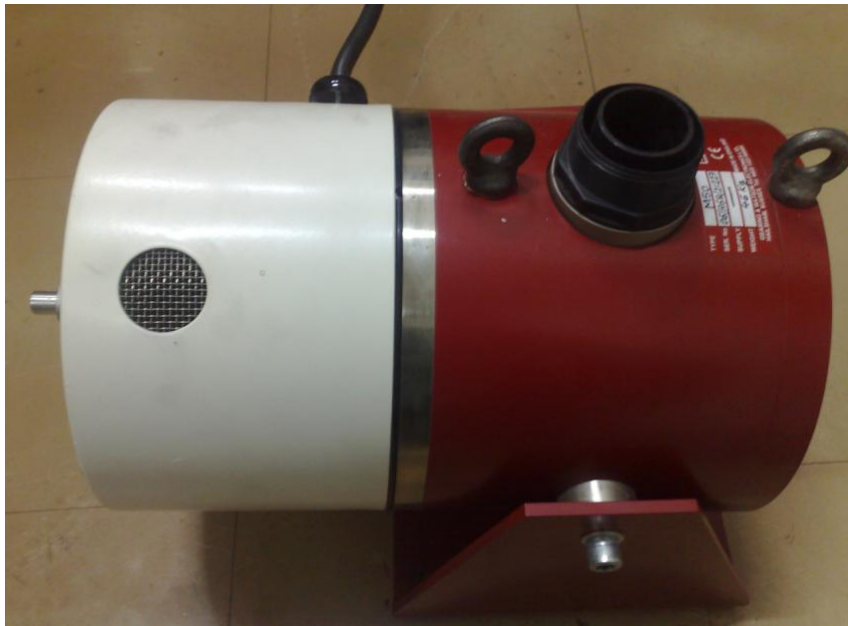
Figura 4.3: Shaker eletro-dinâmico utilizado como atuador do sistema de HIL.
