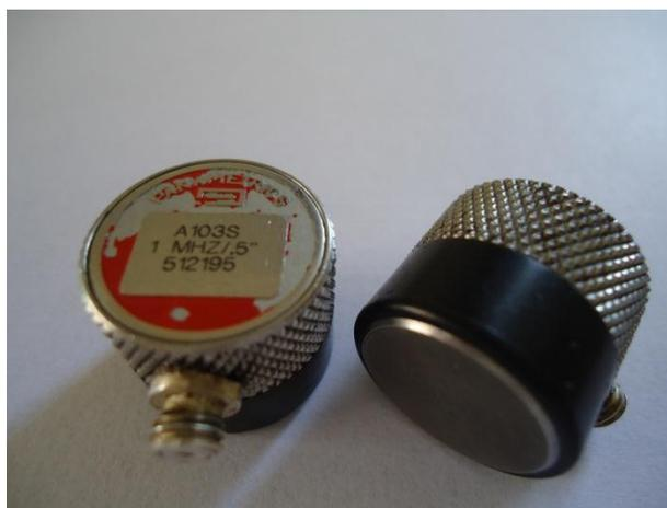
**Figura 33 - Transdutores Panametrics/Olympus® modelo A103S de 1 MHz.**
