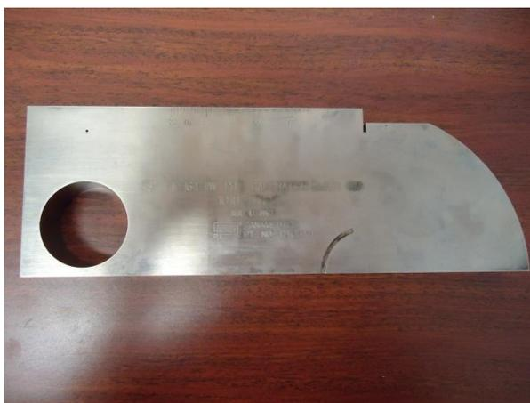
**Figura 34 - Bloco padrão utilizado na calibração dos transdutores.**
