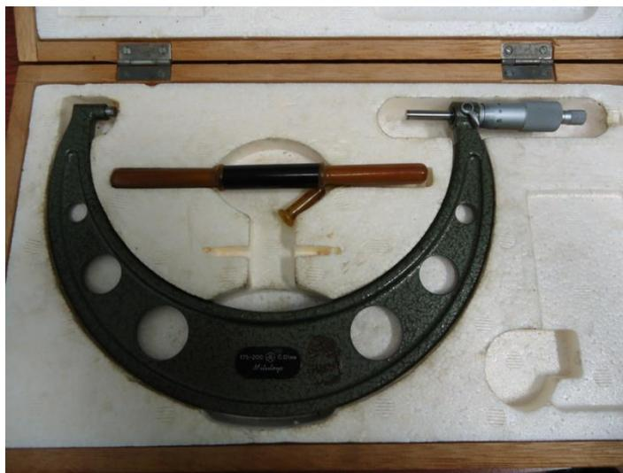
**Figura 35 - Micrometro Mitutoyo utilizado para aferição das medidas das distâncias percorridas pela onda.**
