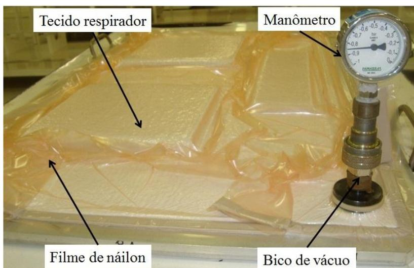
**Figura 26 - Teste de verificação da pressão na bolsa de vácuo.**
