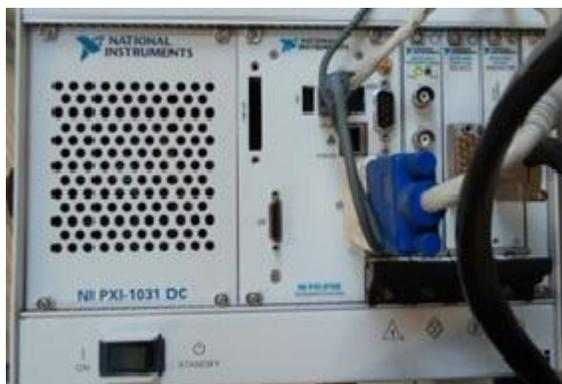
**Figura 37 - Controlador embarcado PXI-8108 da National Instruments®**
