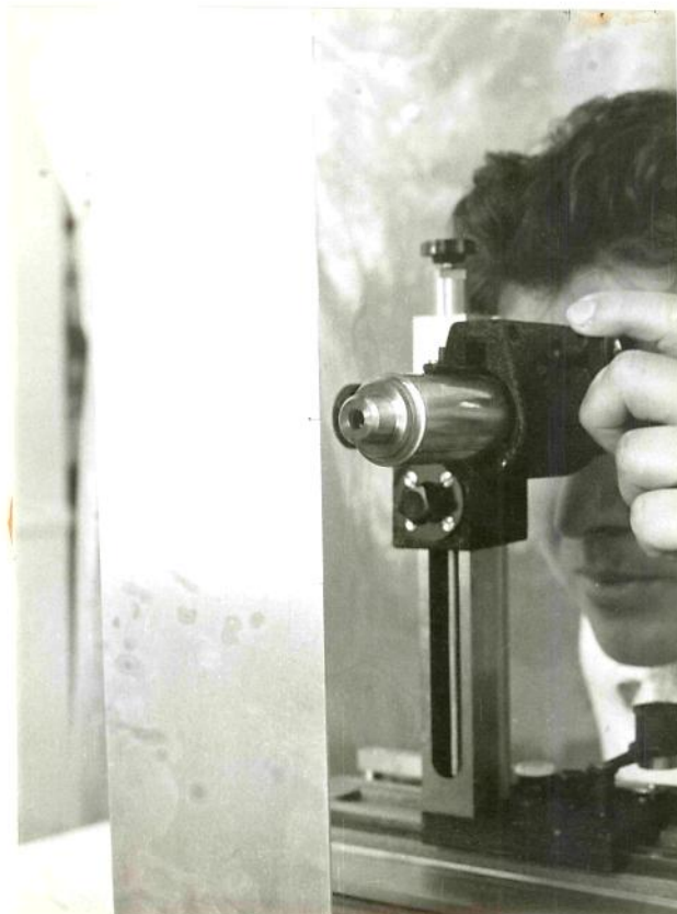
Figura 13 - Leitura do comprimento da trinca.
