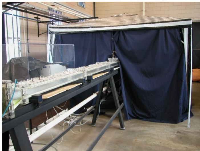
Figura 23 - Câmara escura em torno da seção de testes para realizar os ensaios com o PIV
