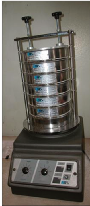
Figura 12 – Agitador eletromagnético de partículas: peneiras de diversos diâmetros + vibrador
