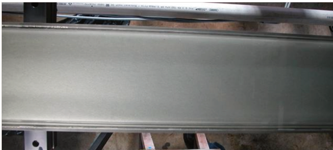
Figura 15 – Seção de teste com o leito rugoso móvel (esferas de vidro “soltas”)
