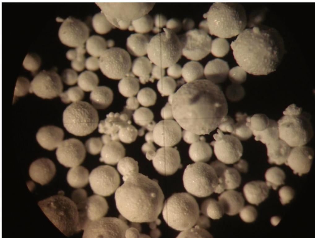
Figura 19 – Microesferas verdes produzidas com velocidade de agitação de 500RPM.
