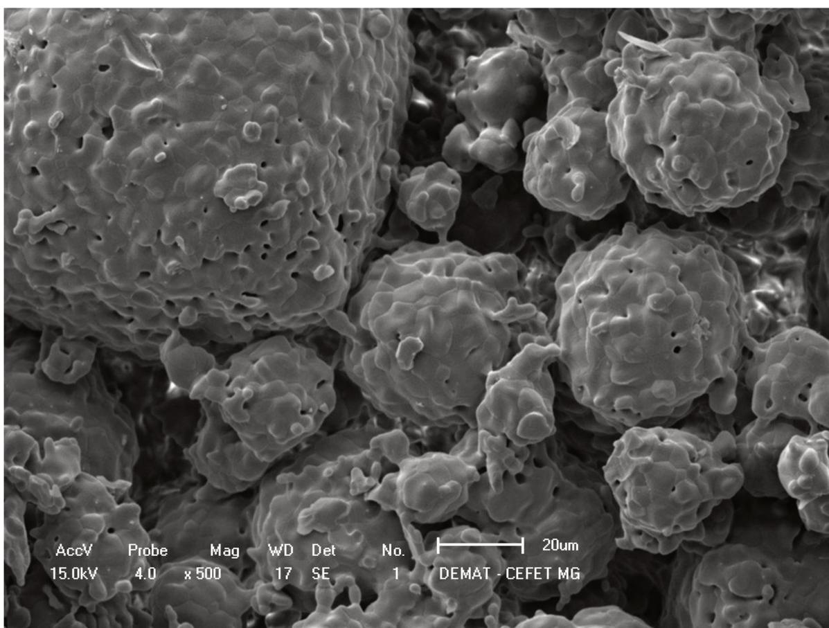
Figura 28 - Imagem de MEV de microesferas sinterizadas a 1400°C/1h.
