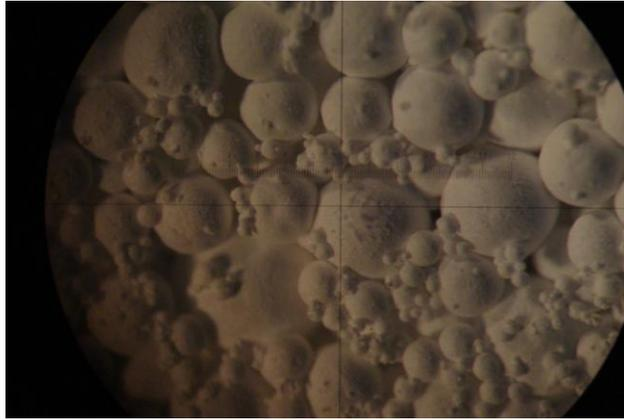
Figura 12 – Imagem de estereomicroscopia de uma peça produzida a partir de microesferas.
