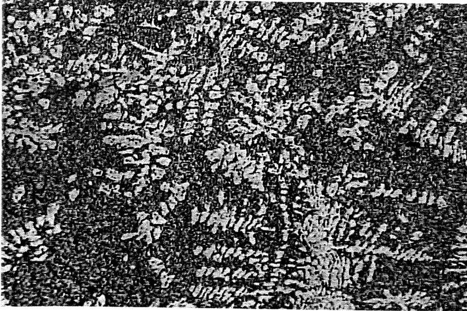
Figura 6.5 – Microestrutura da liga AlSi12 na condição “como recebido”, 500 x , sem ataque químico.
