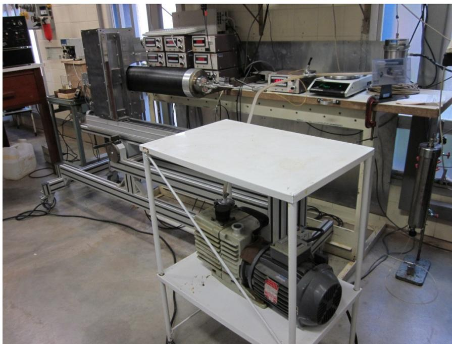
**Figura 4.5.** Imposição de vácuo na amostra, através da bomba de vácuo.
