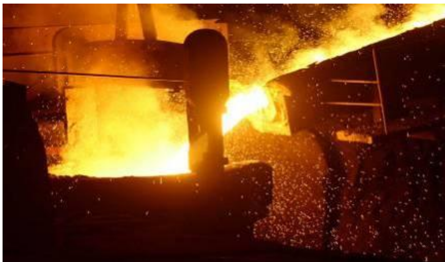
Figura 2.13 Momento do vazamento do aço líquido do forno para a panela. [GALERIA DE FOTOS DA AMSTED MAXION, 2011].
