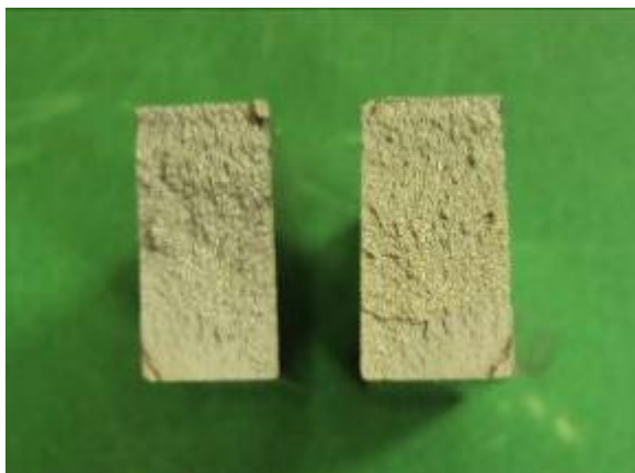
Figura 3.21 Superfície de fratura de um corpo-de-prova da Roda RFo5, após o ensaio de fadiga [SYME QUEIROZ, 2011].
