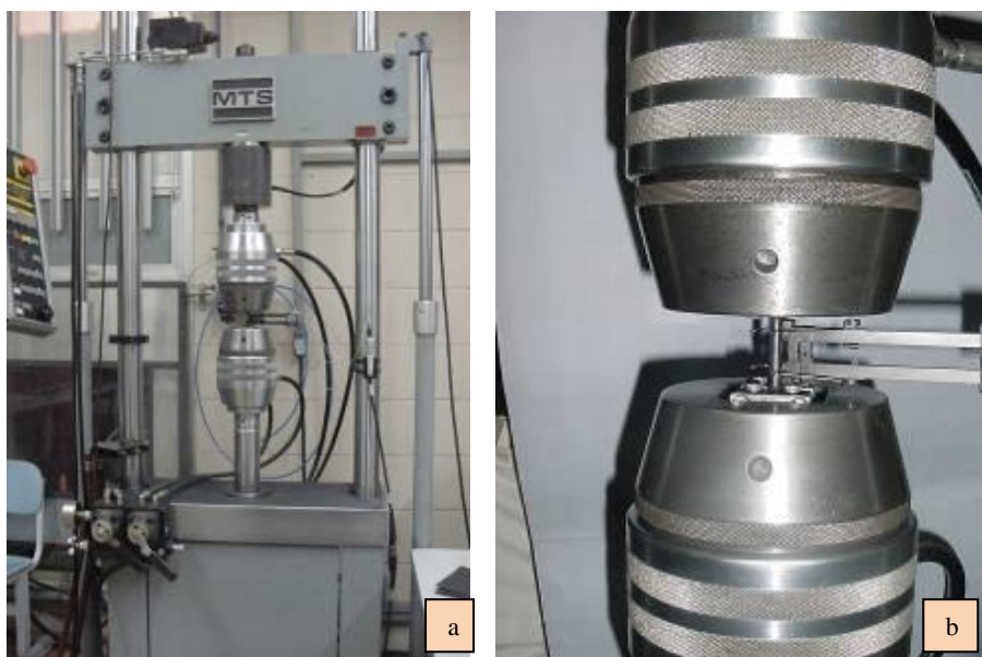
Figura 3.12 Montagem experimental da máquina de ensaios MTS, do Laboratório de Engenharia de Materiais da Unicamp, durante os ensaios: (a) geral e (b) corpo-de-prova fixado nas duas extremidades e o extensômetro [SYME QUEIROZ, 2011].
