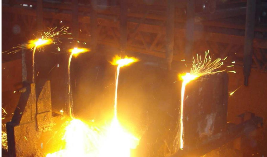
Figura 2.17 Lingotes no momento do corte. Foto gentilmente cedida pela empresa MWL Brasil [VILLAS BOAS, 2009].
