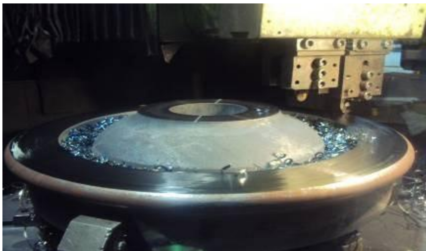
Figura 2.19 Operação de usinagem do disco interno de uma roda ferroviária forjada. Uso gentilmente concedido pela empresa MWL do Brasil [SYME QUEIROZ, 2011].
