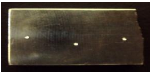
Figura 3.10 Corpo de prova utilizado nos ensaios de fadiga após o ensaio de dureza Rockwell C [SYME QUEIROZ, 2011].
