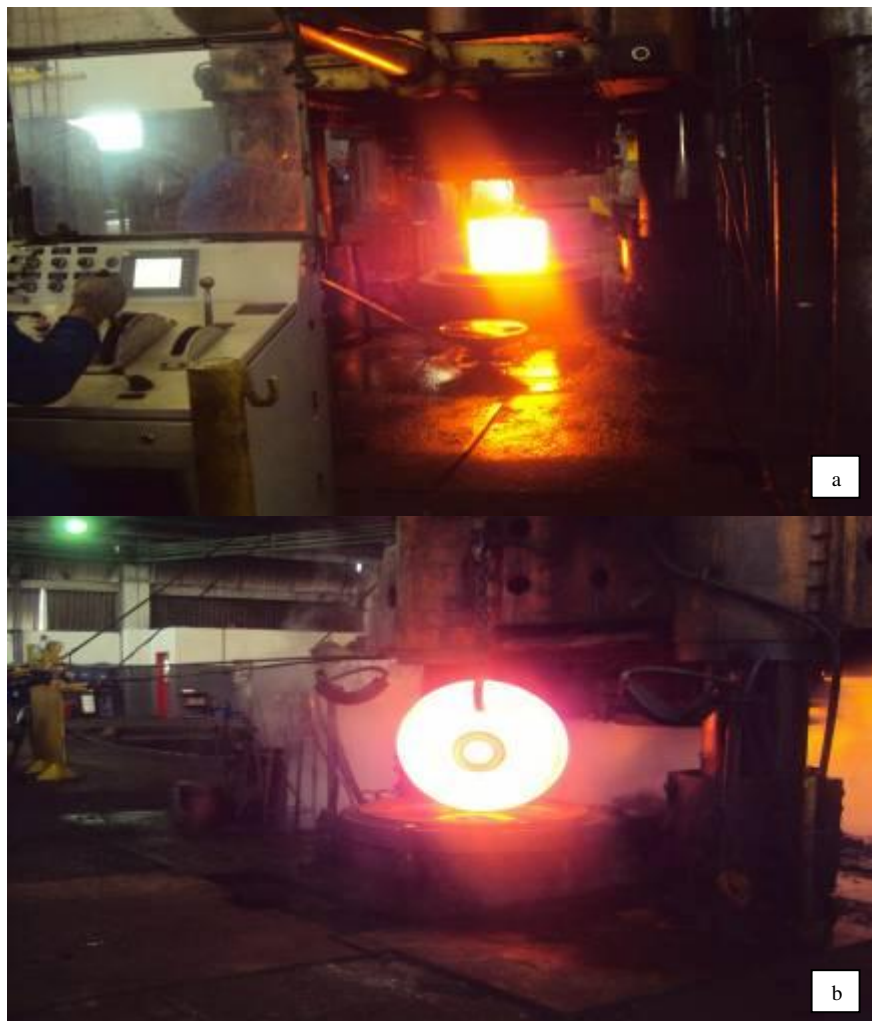
Figura 2.18 (a) Lingote na prensa hidráulica; (b) Lingote moldado em forma de roda saindo da prensa hidráulica. Uso gentilmente concedido pela empresa MWL do Brasil [SYME QUEIROZ, 2011].
