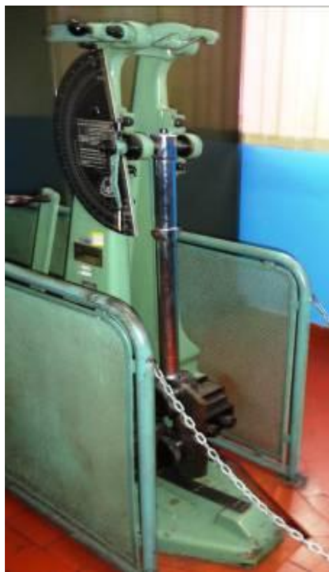
Figura 3.14 Equipamento do tipo Pêndulo de Impacto LOS, do laboratório de ensaios da empresa MWL Brasil, utilizado nos ensaios de impacto – Charpy. Foto gentilmente cedida pela empresa MWL Brasil.
