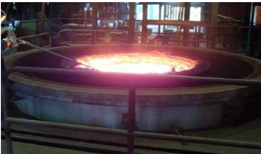
Figura 2.16 Tanque de vácuo com o aço líquido desgaseificado antes do vazamento na lingoteira. Foto gentilmente cedida pela empresa MWL Brasil [VILLAS BOAS, 2009].
