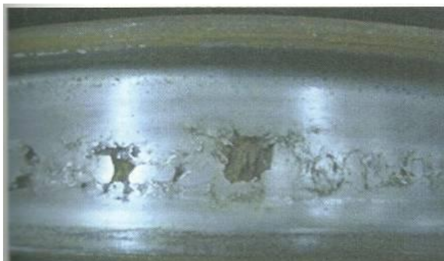
Figura 2.23 Parte de uma roda ferroviária com defeito de Escamação – Shelling [CLARKE, 2008].
