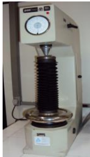
Figura 3.9 Durômetro Pantec RBS utilizado nos ensaios de dureza Rockwell C [SYME QUEIROZ, 2011].
