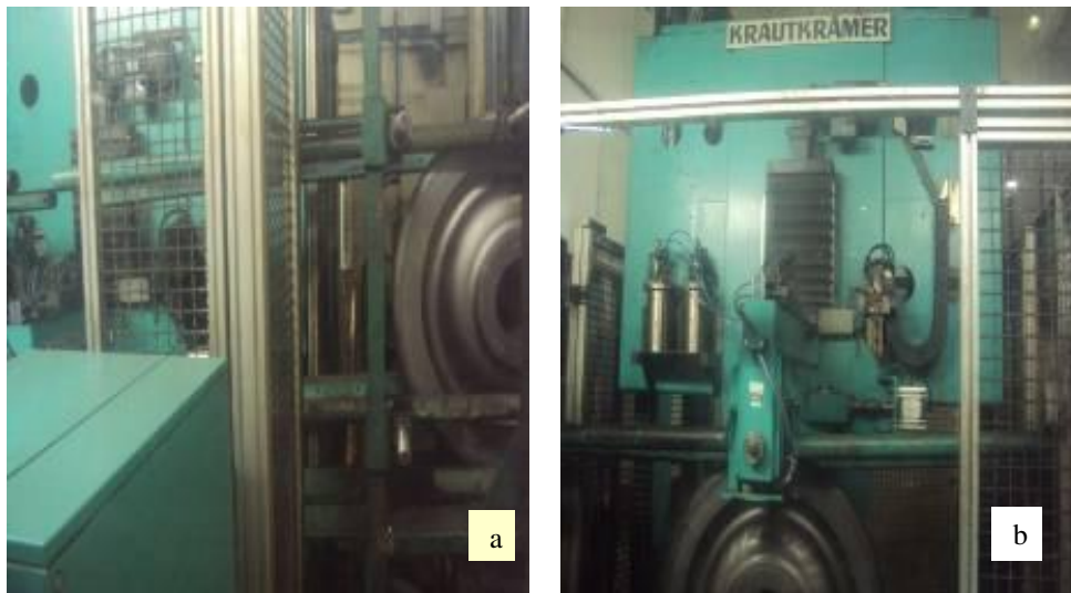
Figura 2.20 (a) Roda ferroviária forjada entrando no aparelho de ultra-som, (b) Roda ferroviária forjada durante o procedimento de ultra-som. Uso gentilmente concedido pela empresa MWL do Brasil [SYME QUEIROZ, 2011].
