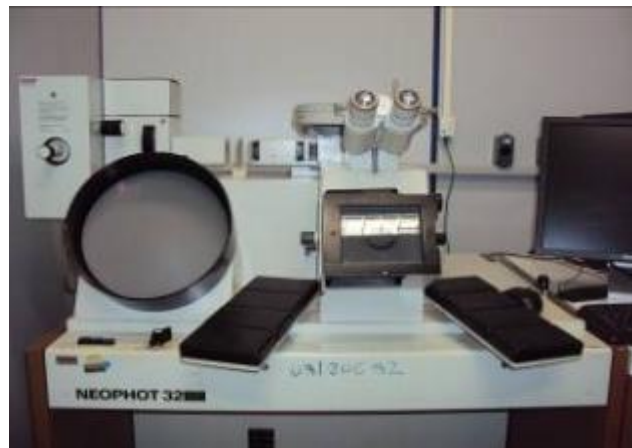
Figura 3.7 Microscópio óptico Neophot 32, do Laboratório de Engenharia de Materiais da Unicamp, utilizado na análise metalográfica [SYME QUEIROZ, 2011].
