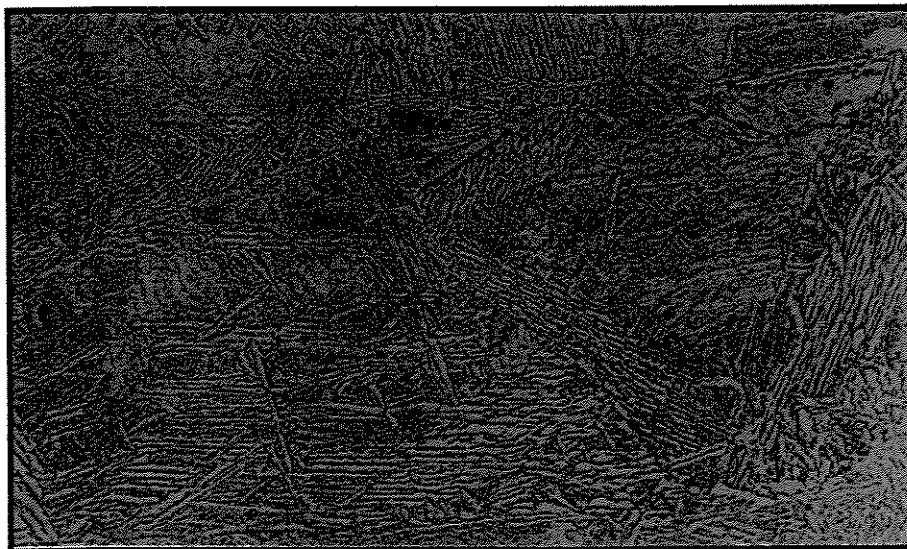
Figura 5.10 – Microestrutura da ZATRGG obtida com, energia de soldagem de 2,5 kJ/mm à temperatura de 75°C. Ataque Nital 2%.
