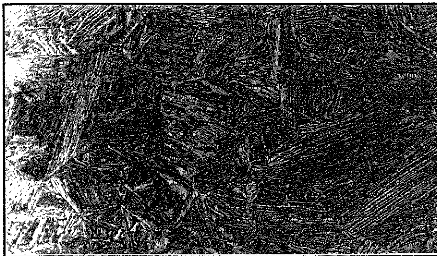
Figura 5.12 – Microestrutura da ZATRGG obtida com, energia de soldagem de 3,0 kJ/mm à temperatura ambiente.
