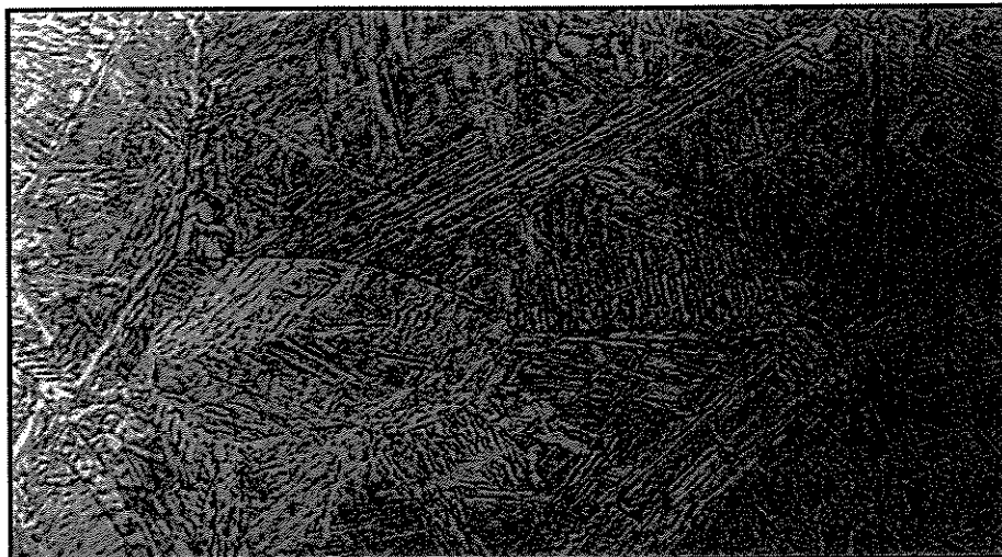
Figura 5.14 – Microestrutura da ZATRGG obtida com, energia de soldagem de 3,0kJ/mm à temperatura de 100°C.
