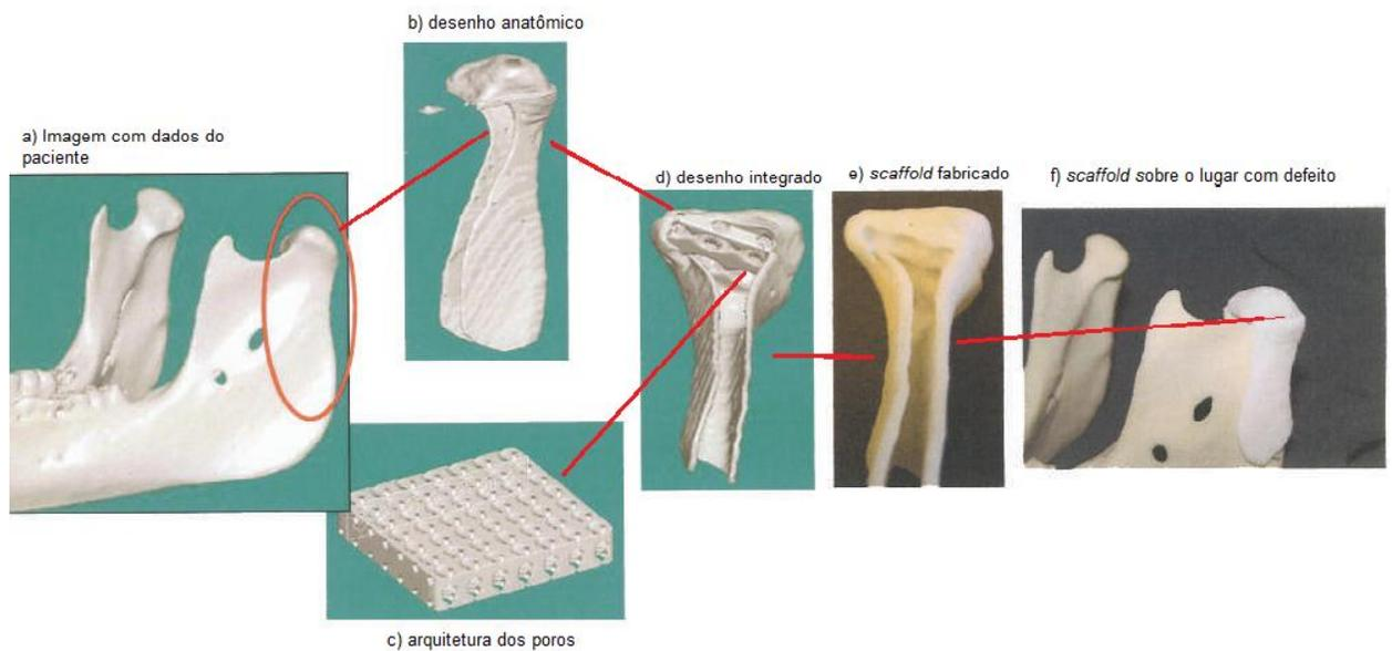
Figura 2.7- Processo de integração macroestrutural projetado com scaffold de formato anatômico [Hollister,2009b].
