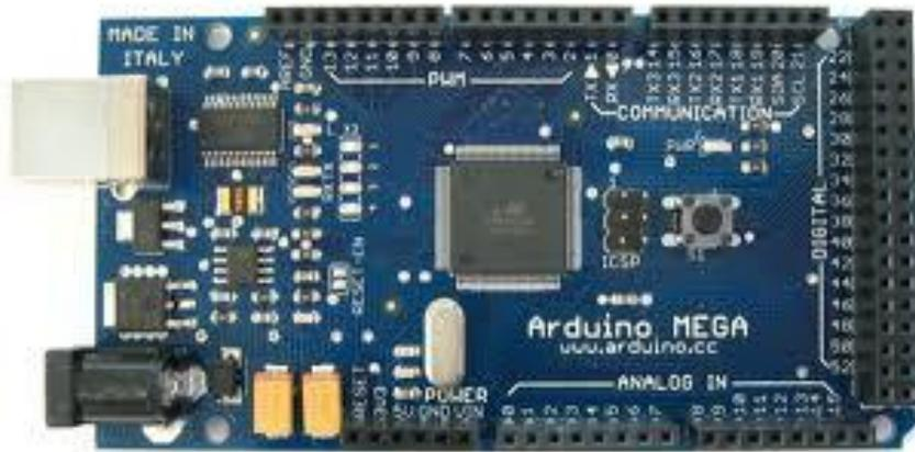
**Figura 3.11. Placa Arduino Mega 2550**
