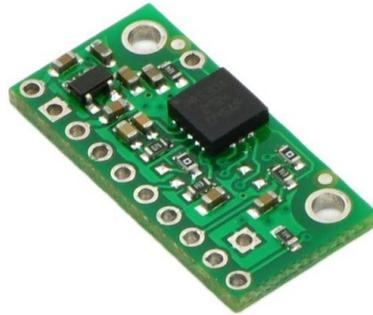
**Figura 3.15. Giroscópio de três eixos LPR510AL**
