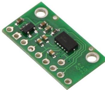
**Figura 3.14. Acelerômetro de três eixos MMA7361L**
