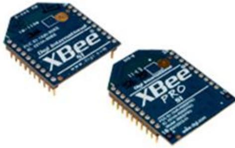
**Figura 3.12. Transmissor XBee PRO 802.15.4**
