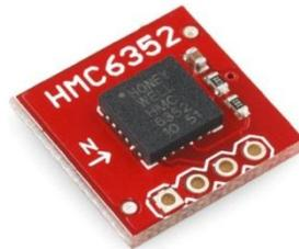
**Figura 3.16. Bússola Sparkfun modelo HMC6352**
