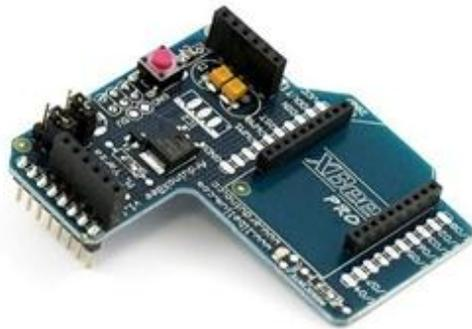
**Figura 3.13. Shield Arduino XBee sem transmissor**
