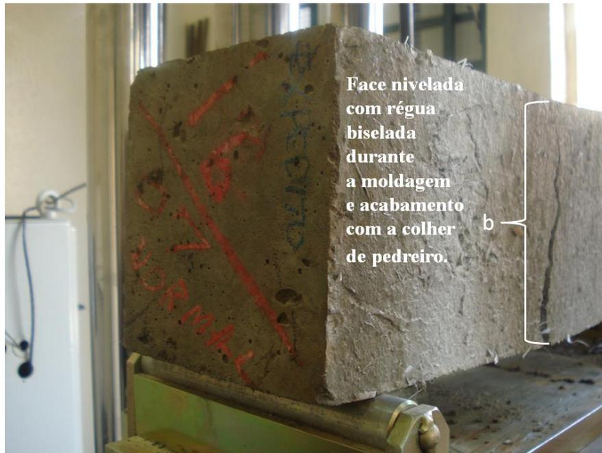
Figura 3.18 - Fotografia do posicionamento do corpo-de-prova no dispositivo de flexão
