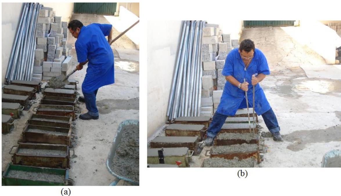
Figura 3.12 - Fotografia do lançamento e adensamento nas formas para confecção dos corpos-de-prova utilizados neste trabalho: (a) lançamento nas formas; (b) adensamento do concreto.
