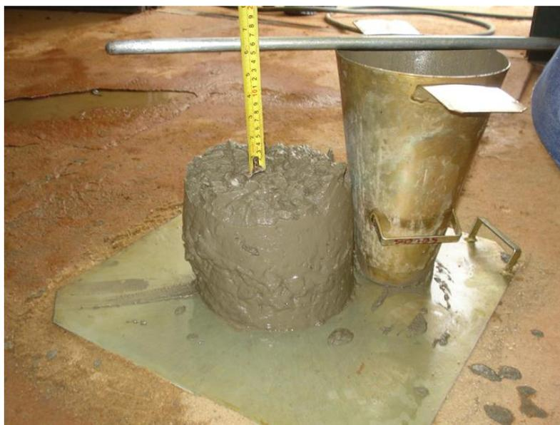
Figura 4.3 - Fotografia do concreto após o ensaio de abatimento pelo tronco de cone
