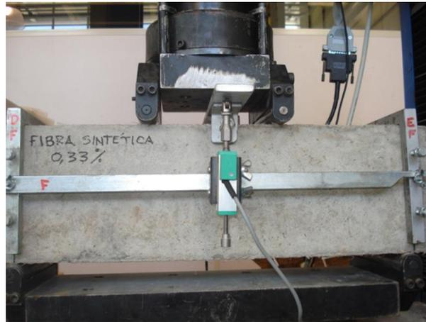
Figura 3.21 - Fotografia do dispositivo do YOKE de fixação do LVDT no corpo-de-prova
