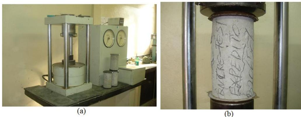
Figura 3.15 - Fotografia da prensa utilizada neste trabalho: (a) Vista geral da prensa hidráulica para ensaio de compressão axial; (b) Detalhe do rompimento do corpo-de-prova
