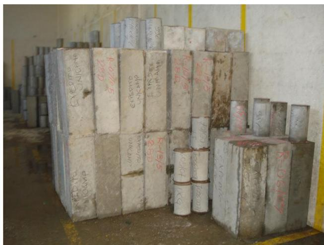
Figura 3.13 - Fotografia dos corpos-de-prova utilizados neste trabalho confinados em câmara úmida
