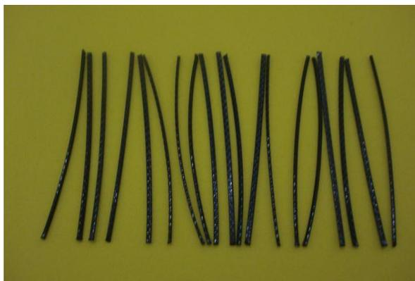
Figura 2.4 - Fotografia de fibras de polipropileno do tipo multifilamento.
