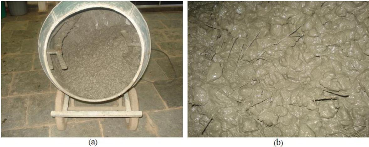
Figura 3.10 - Fotografia da mistura dos componentes do concreto: (a) Betoneira com a mistura; (b) Mistura concluída utilizada neste trabalho
