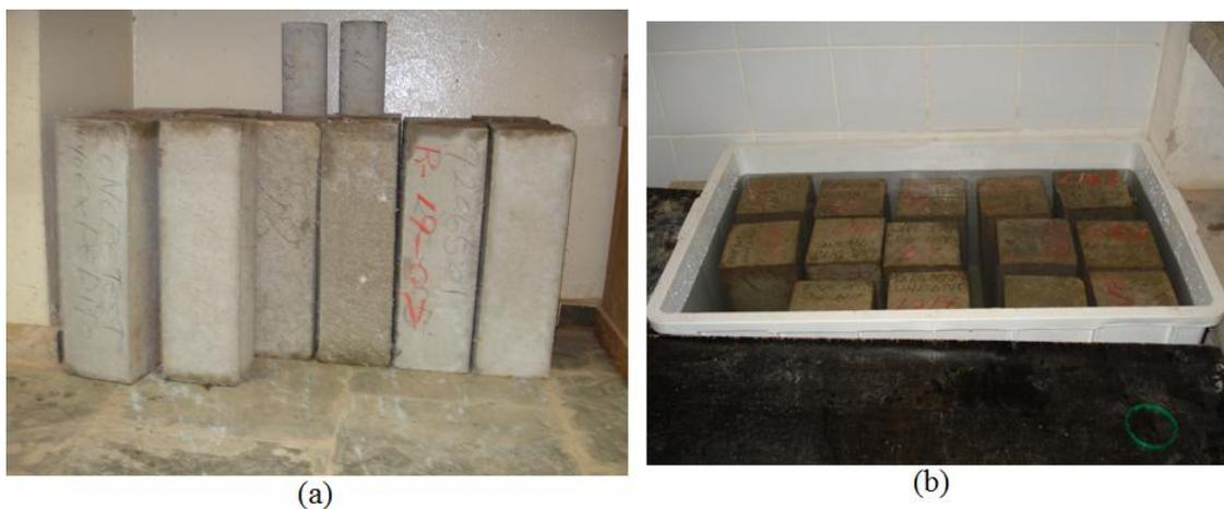
Figura 3.14 - Fotografia dos corpos-de-prova utilizados neste trabalho: (a) expostos em ambiente normal (ao ar); (b) expostos em meio agressivo em solução aquosa em 3% em peso de NaCl
