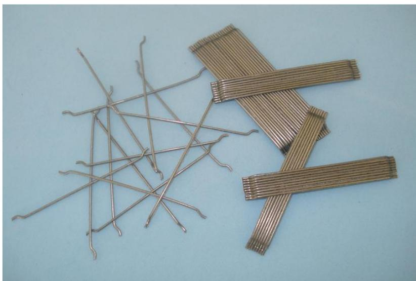
Figura 3.9 - Fotografia das fibras e pentes de fibras de aço utilizadas neste trabalho
