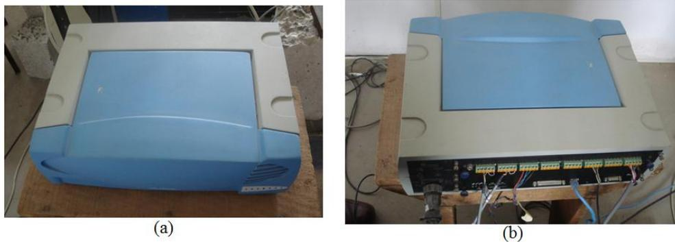
Figura 3.24 - Fotografia do aquisitor de dados: (a) vista frontal; (b) vista posterior
