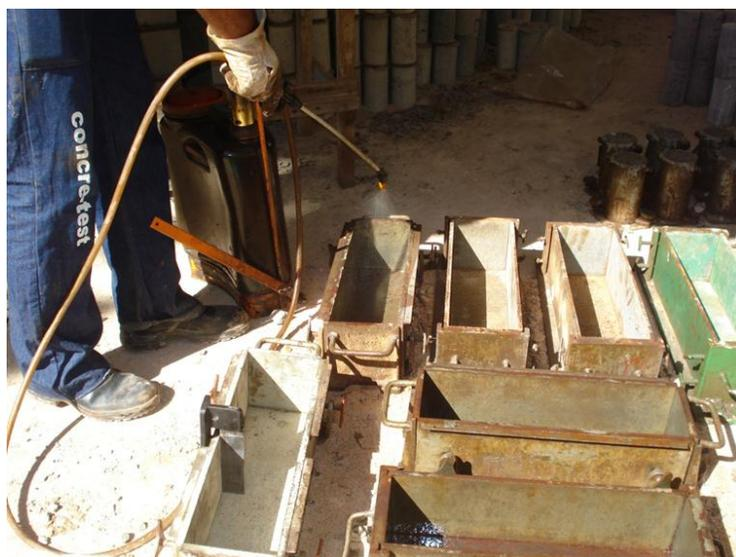
Figura 3.11 - Fotografia do borrifamento nas formas utilizadas na confecção dos corpos-de-prova
