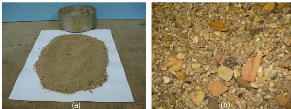
Figura 3.6 - Fotografia das condições da areia utilizada neste trabalho: (a) areia seca antes do peneiramento; (b) impurezas encontradas no peneiramento
