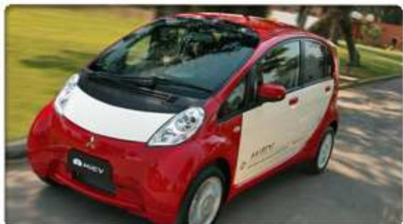
**Motor:** 80 kW (107 cv) bateria de ion-lítio
