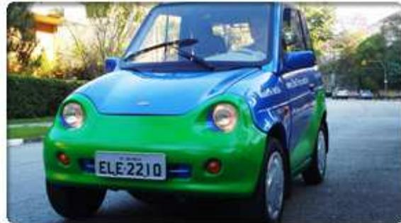
**Motor:** 13 kW (18 cv) bateria de chumbo ácido
